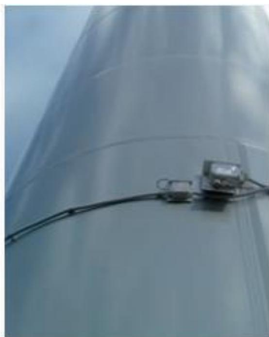
navicella o sulla torre, al fine di avere una migliore sorveglianza possibile nell'area di rotazione delle turbine
