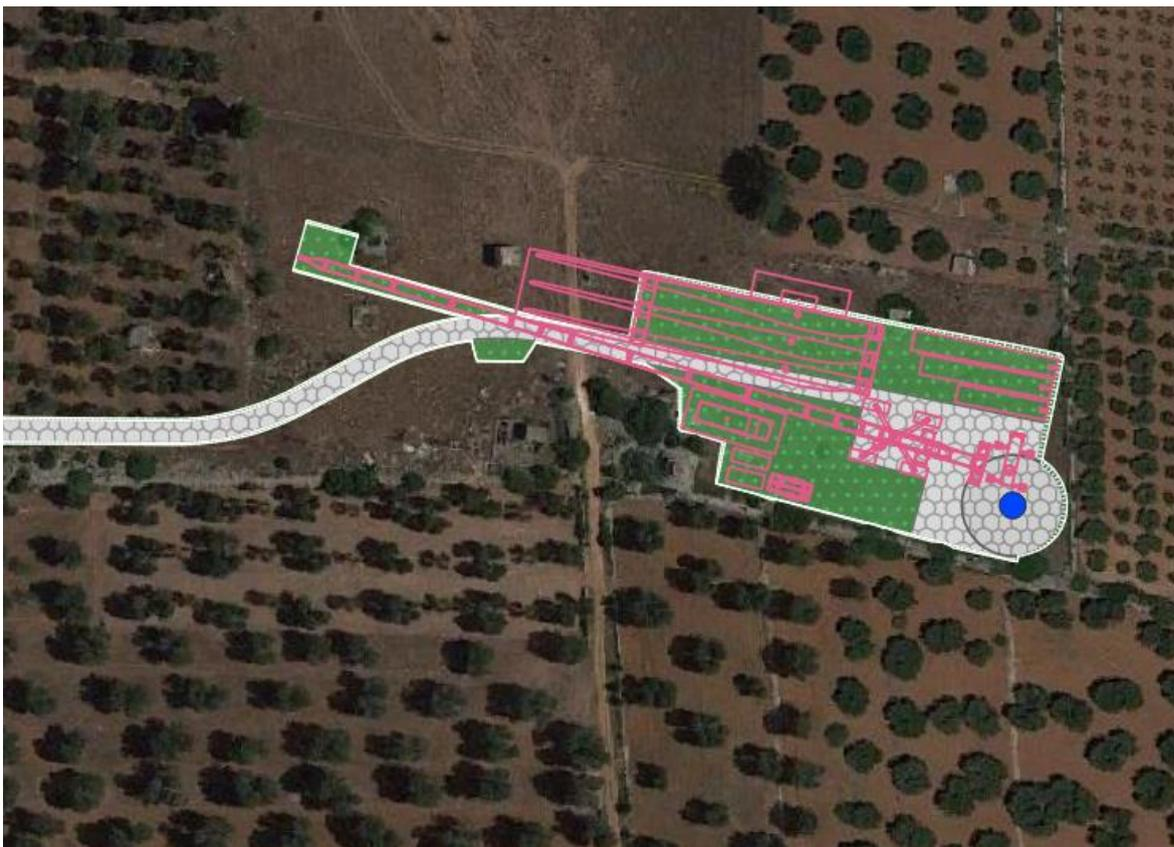
La richiesta conformazione del terreno (sistema piazzola + sbraccio gru) determinerà lo scavo di circa 350 m<sup>3</sup> di materiale, al netto dello scavo delle strutture di fondazione dell'aerogeneratore (pari a circa 1.250 m<sup>3</sup>) ed il posizionamento in rilevato di 255 m<sup>3</sup> di materiale oltre a quello impiegato per il rinterro della fondazione.
