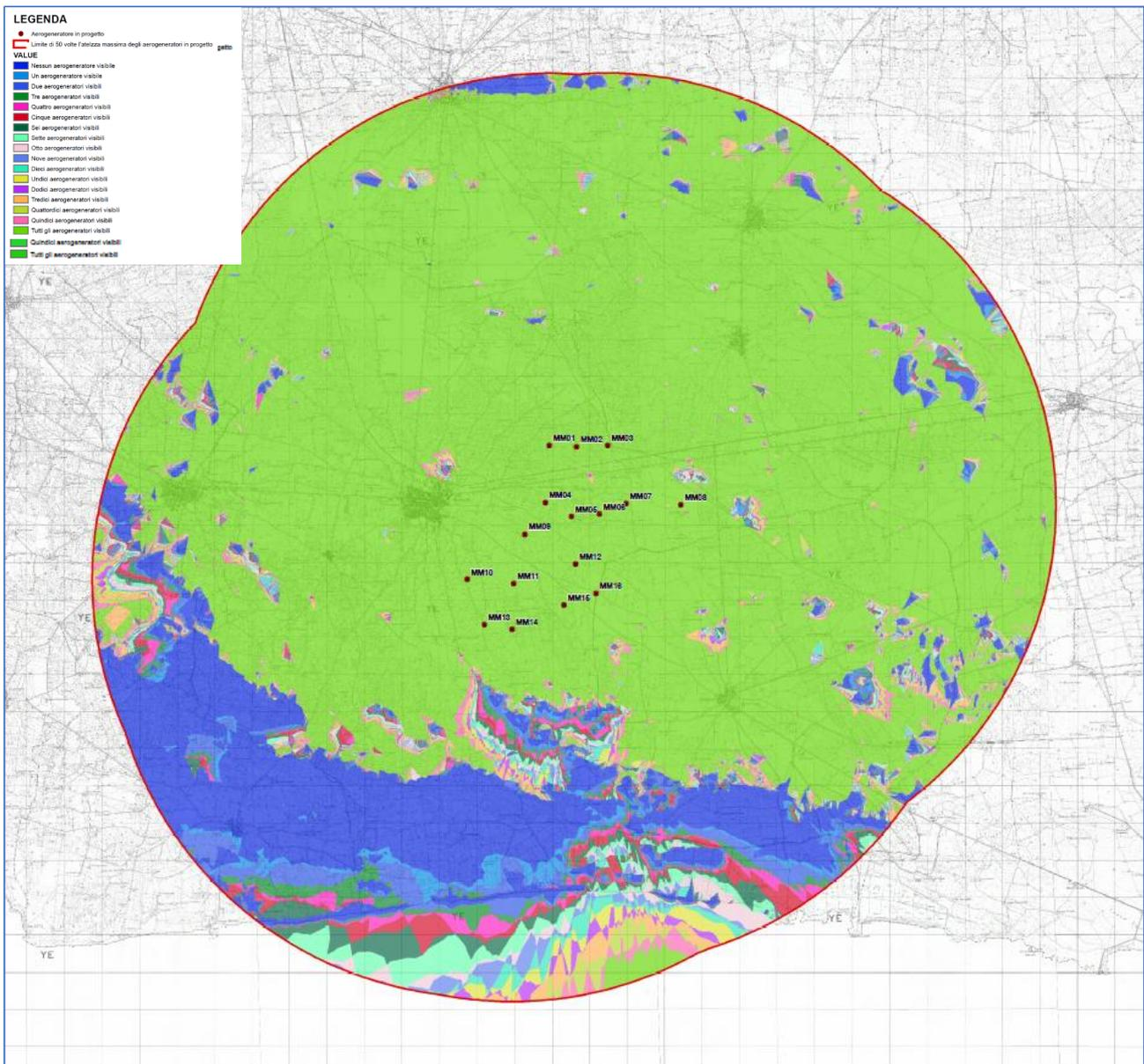
Figura 2 - Mappa dell'intervisibilità degli aerogeneratori - metodo 1
