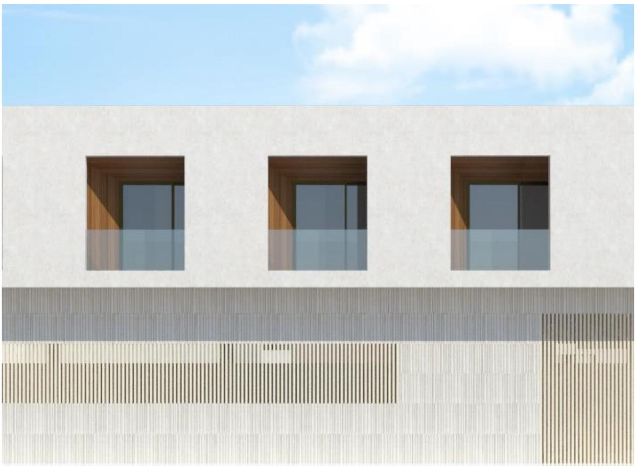
*Render della facciata di progetto. È visibile il basamento ad effetto materico con le integrazioni delle aerazioni tecniche trattate con un rivestimento a listelli, mentre sopra il volume camere con la stessa finitura cromatica ma liscia. Dalle aperture delle camere si intravede il rivestimento delle logge in teak.*
