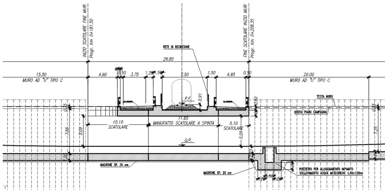
Figura 1: Sezione longitudinale tipo di un sottovia
