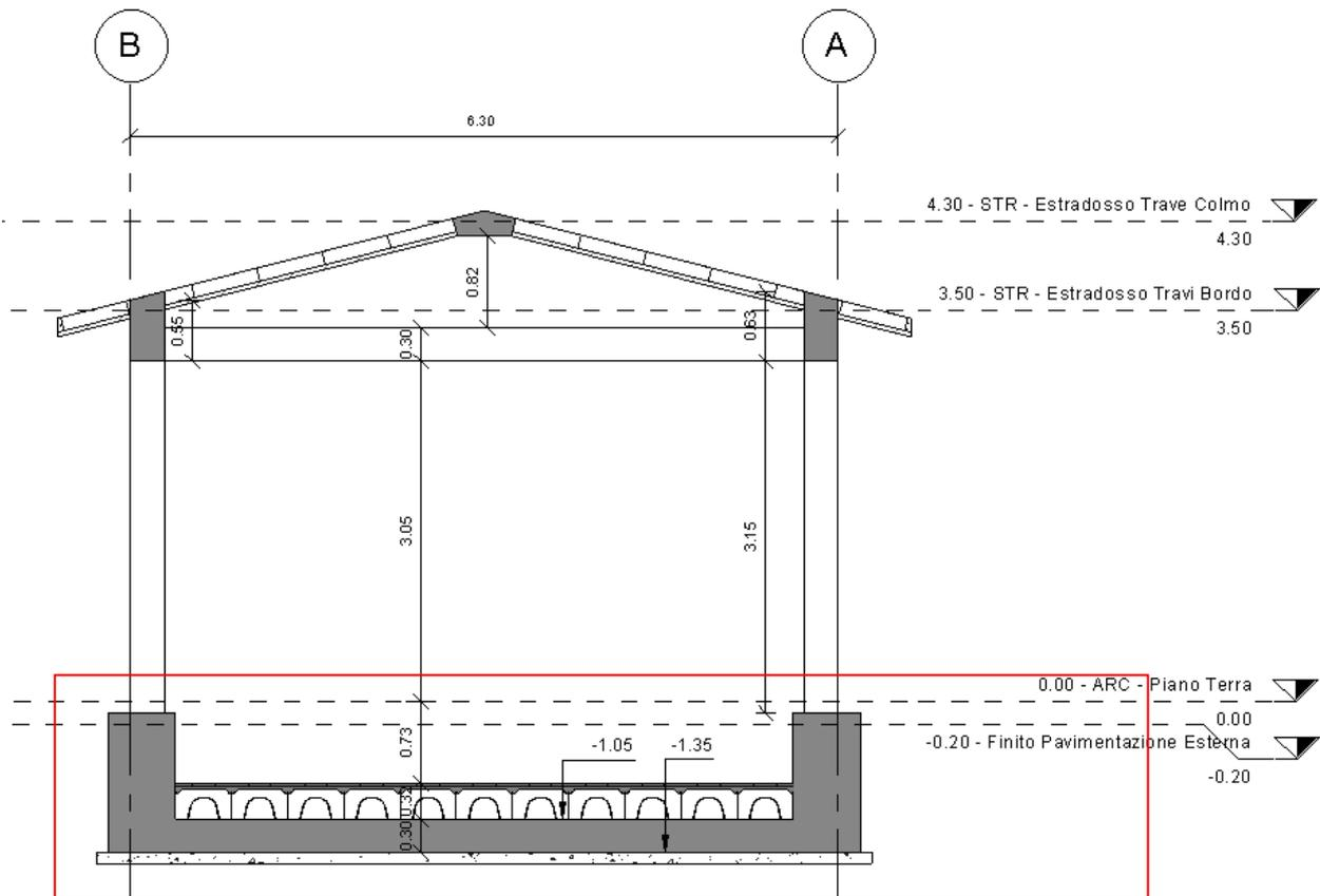
**Fig. 4: Fabbricato tecnologico. Sezione strutturale esemplificativa. Nel riquadro rosso i punti quotati della fondazione.**
