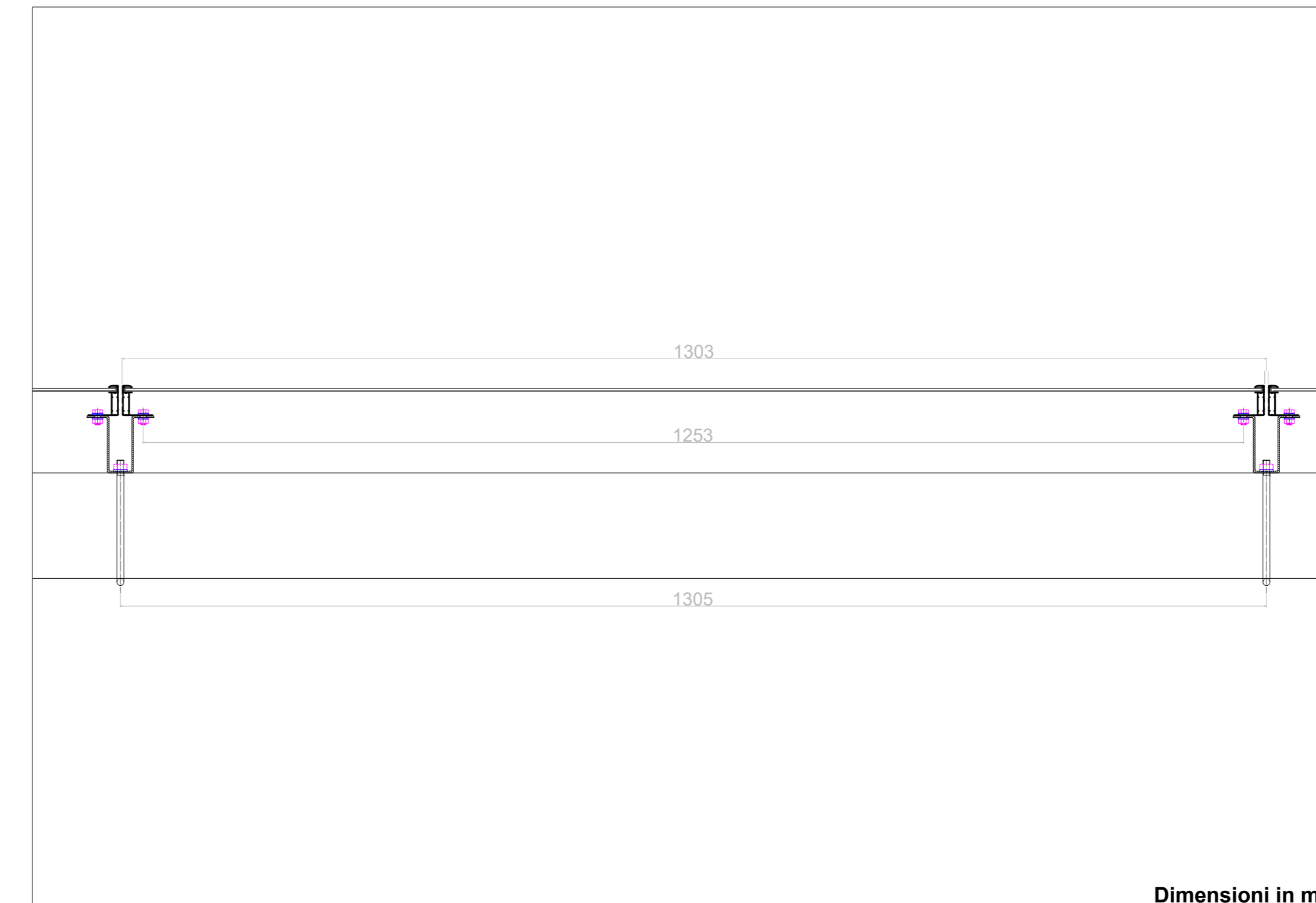
PARTICOLARE ATTACCO DEL PANNELLO SCALA 1:5
