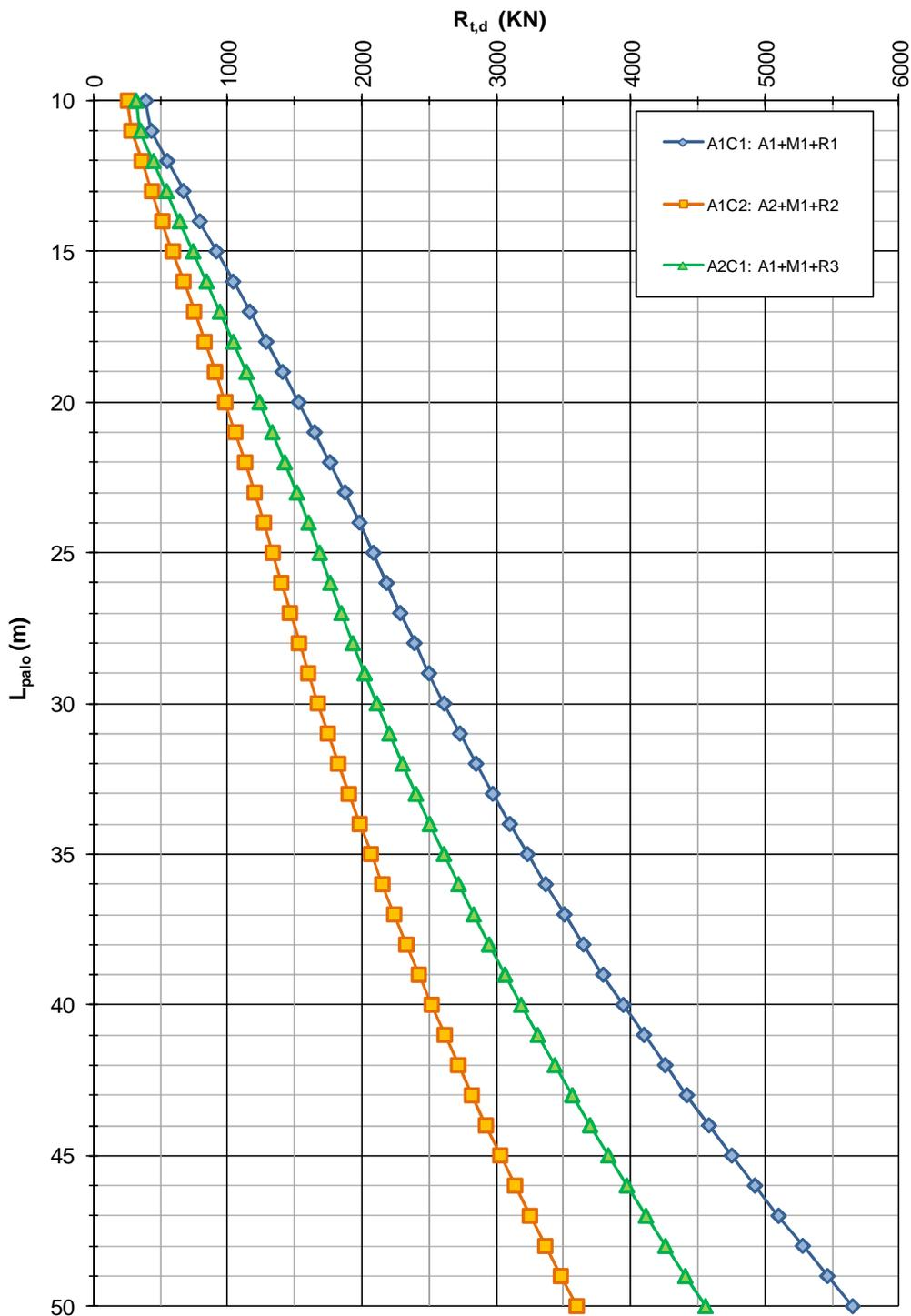
**FIGURA 4-2: CAPACITÀ PORTANTE A TRAZIONE – PALI TRIVELLATI  $\phi$  800**
