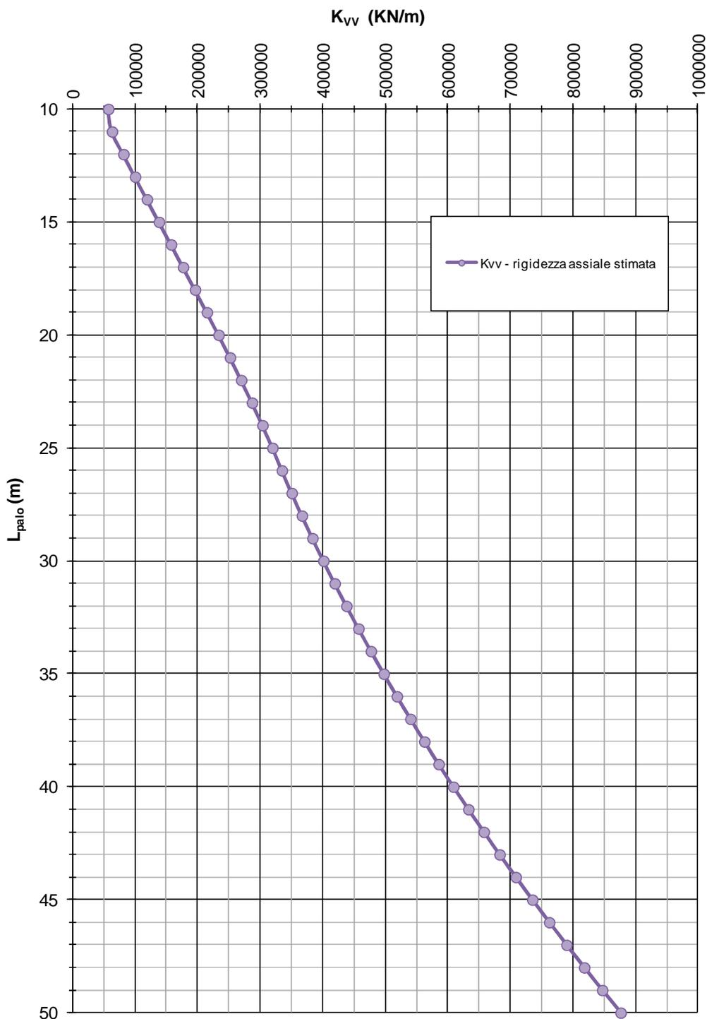
**FIGURA 10-2: RIGIDEZZA VERTICALE – PALI TRIVELLATI  $\phi$  800**
