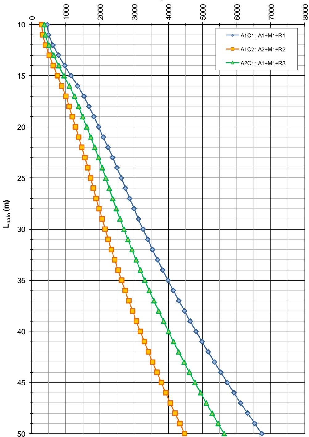
**FIGURA 4-1: CAPACITÀ PORTANTE A COMPRESSIONE – PALI TRIVELLATI  $\phi$  800**
