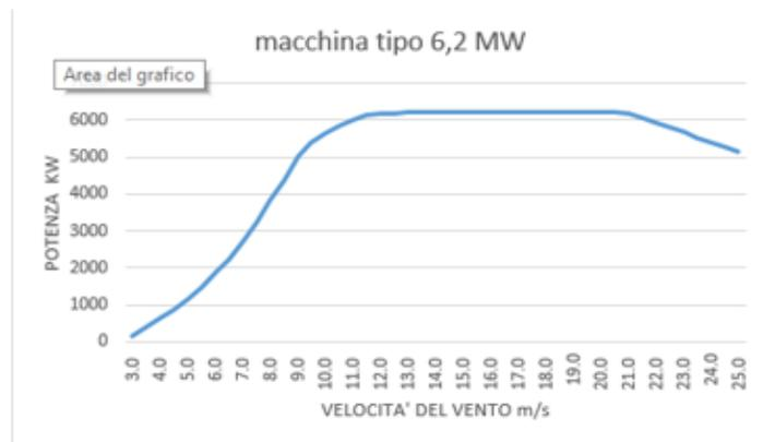
Curva di potenza aerogeneratore tipo
