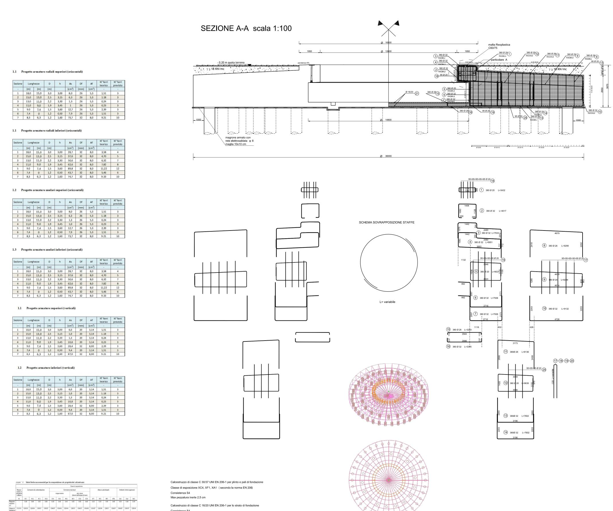
Assonometria e pianta a filo di ferro del Plinto di fondazione
