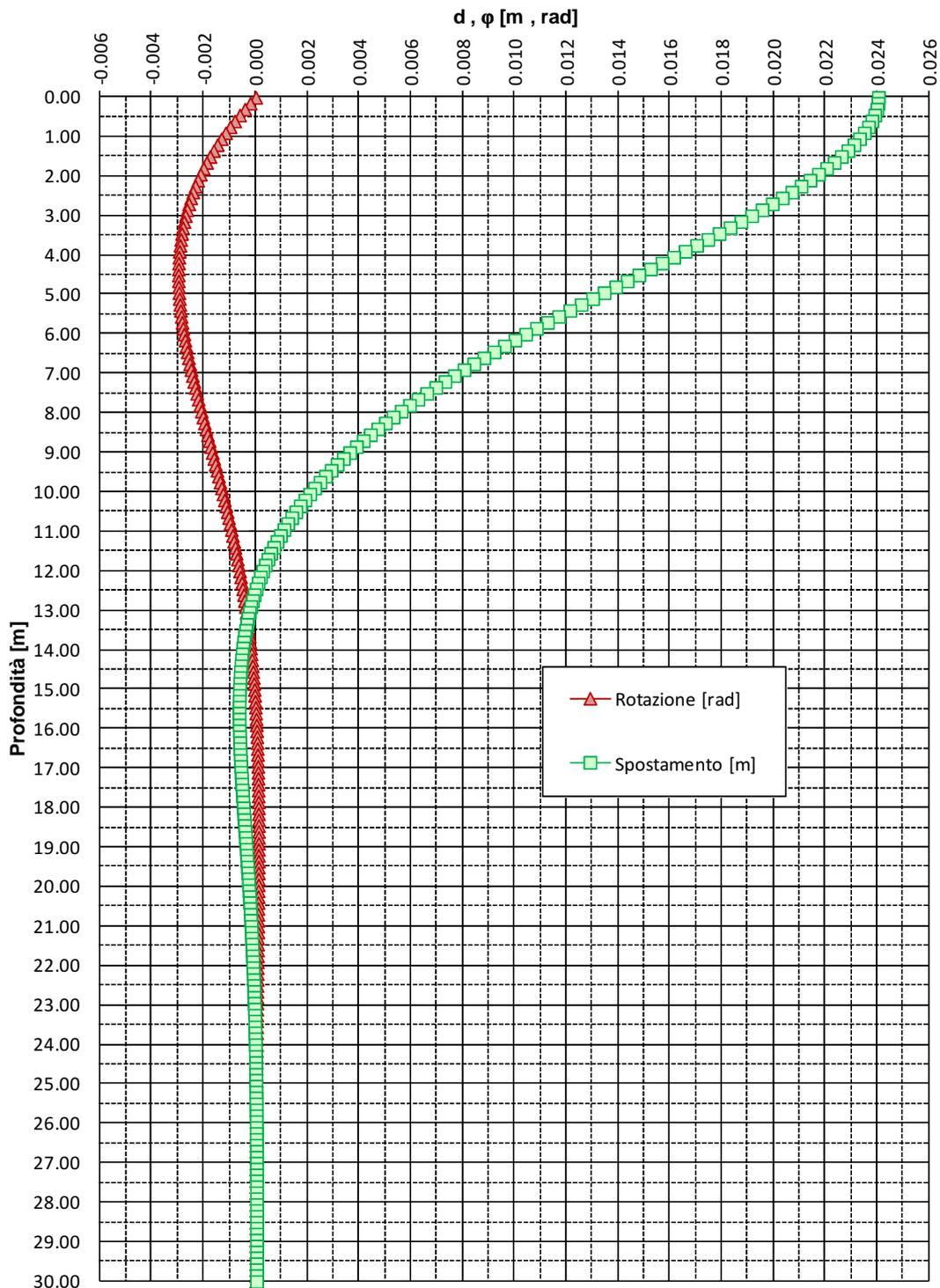
FIGURA 6-2: SPOSTAMENTI E ROTAZIONI – PALI TRIVELLATI φ 1200
