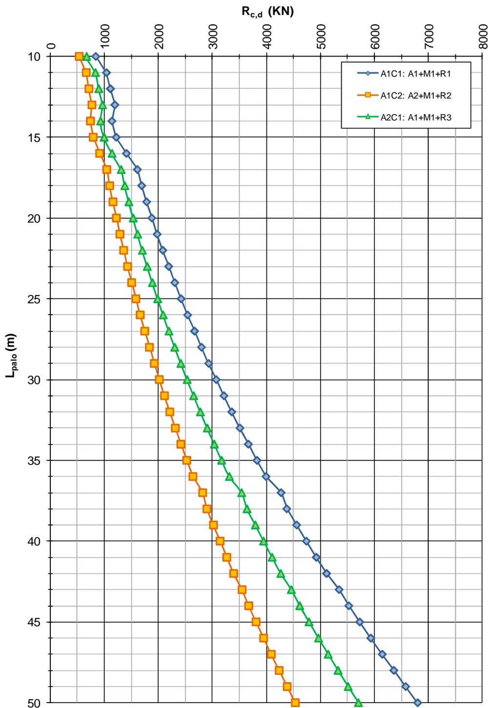
**FIGURA 4-1: CAPACITÀ PORTANTE A COMPRESSIONE – PALI TRIVELLATI  $\phi$  1200**
