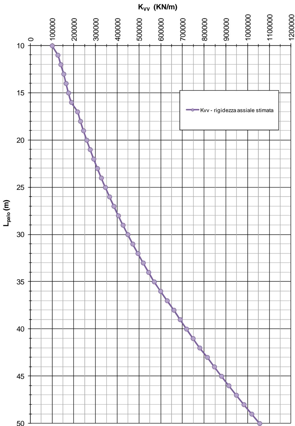
FIGURA 10-2: RIGIDEZZA VERTICALE – PALI TRIVELLATI  $\phi$  1200
