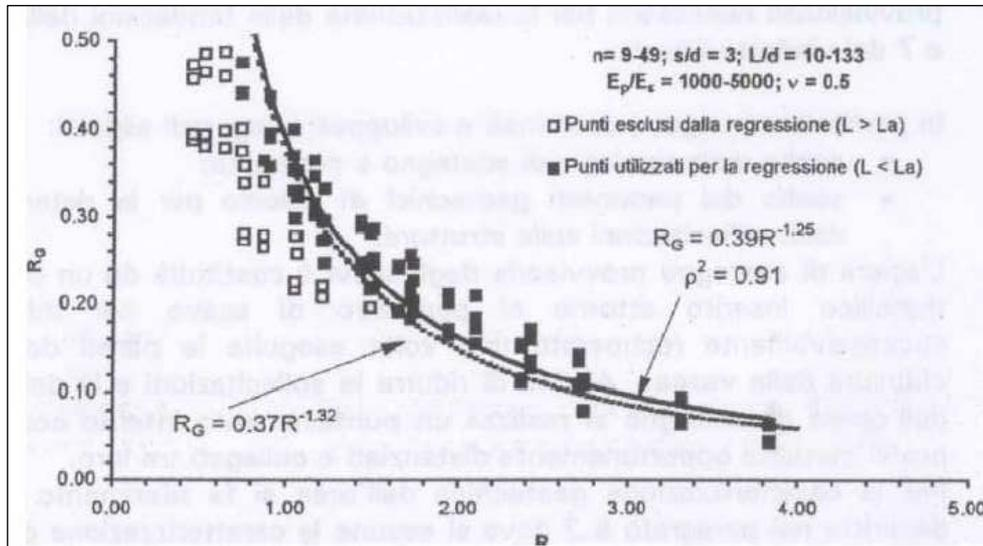
FIGURA 10-1: AMPLIFICAZIONE DEL CEDIMENTO PER EFFETTO GRUPPO
