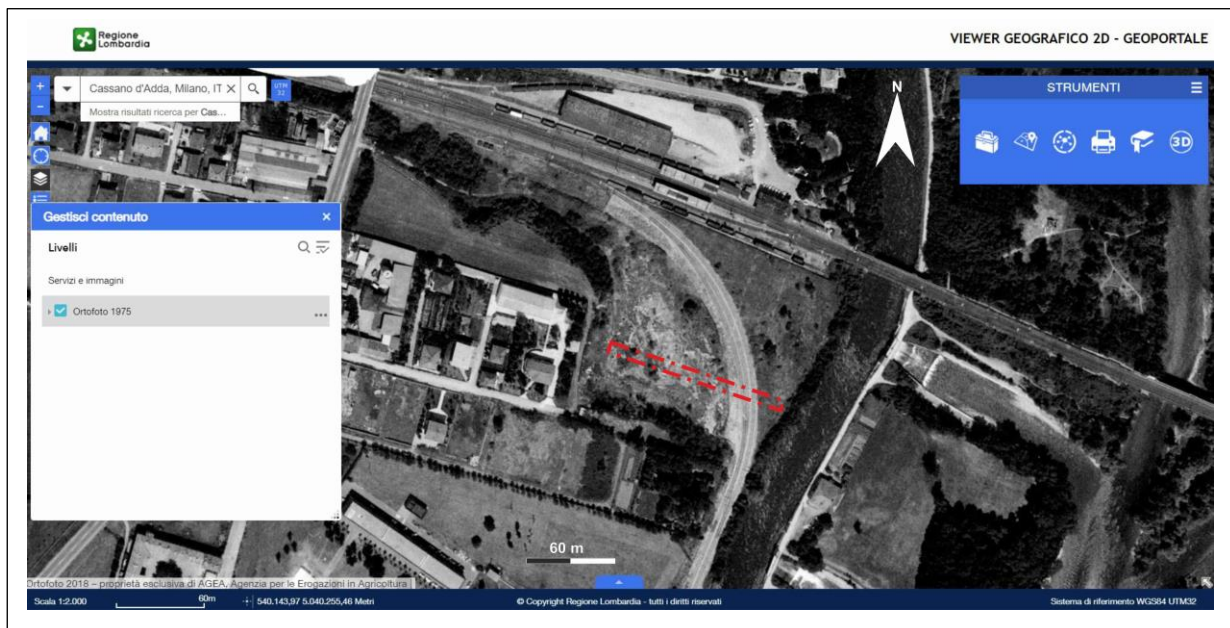
Fig. 14. Ortofoto del 1975 dell'area a nord della centrale in cui è visibile il piccolo tracciato ferroviario. Il rettangolo rosso tratteggiato indica la traccia della trincea paleosismologica.
