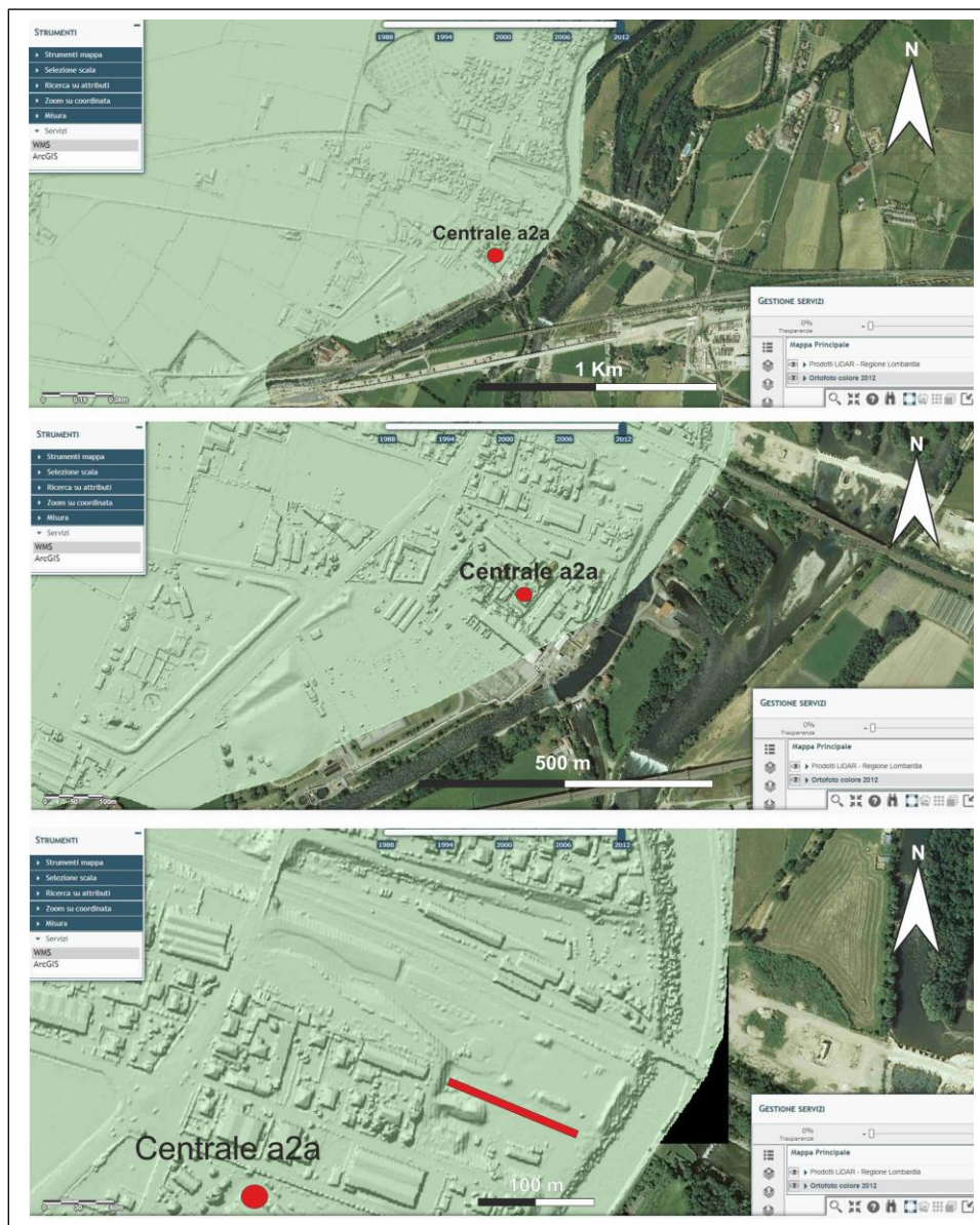
Fig. 11. Modello digitale di terreno da dati LIDAR della zona della centrale a2a. Sono visibili zone depresse e zone rilevate, che sono il prodotto dell'attività antropica nell'area. Il rettangolo rosso indica la traccia della trincea paleosismologica effettuata (si veda testo per la descrizione).
