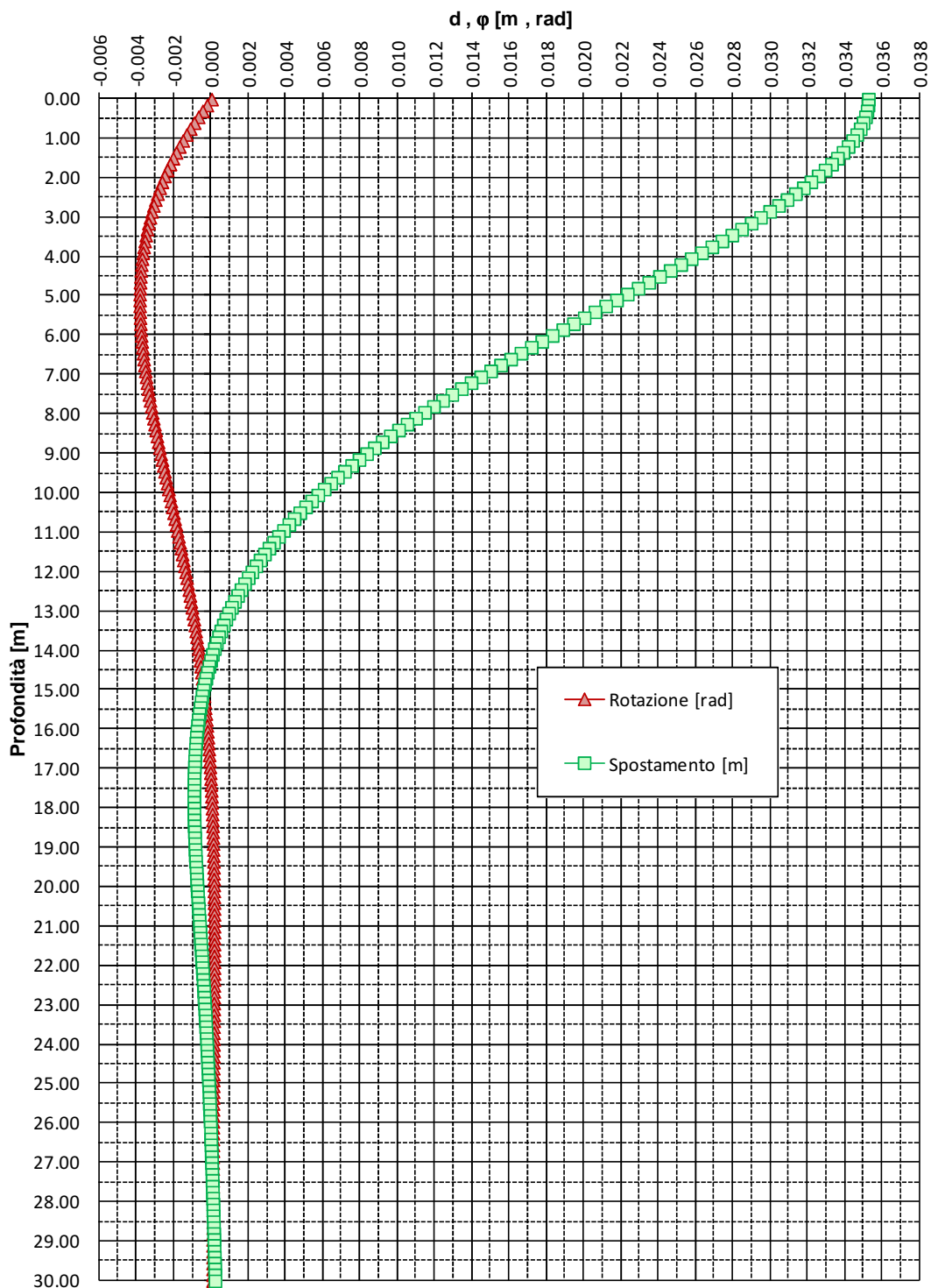
FIGURA 6-4: SPOSTAMENTI E ROTAZIONI – PALI TRIVELLATI \phi 1200
