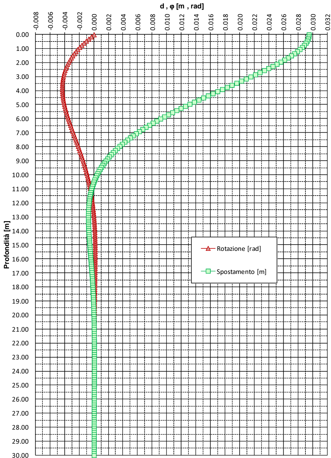
FIGURA 6-2: SPOSTAMENTI E ROTAZIONI – PALI TRIVELLATI \phi 1000
