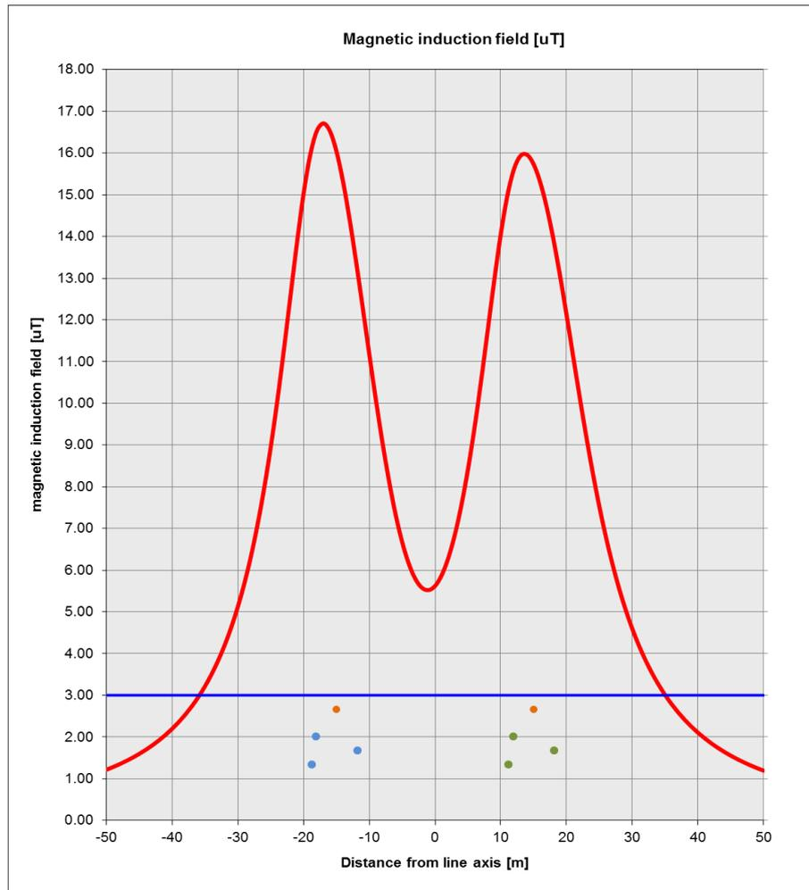
**Fig. 1: andamento dell'induzione magnetica in una sezione perpendicolare agli assi delle linee, calcolata a 1,5 m dal suolo in caso di franco minimo (obiettivo di qualità pari a 3  $\mu$ T)**
