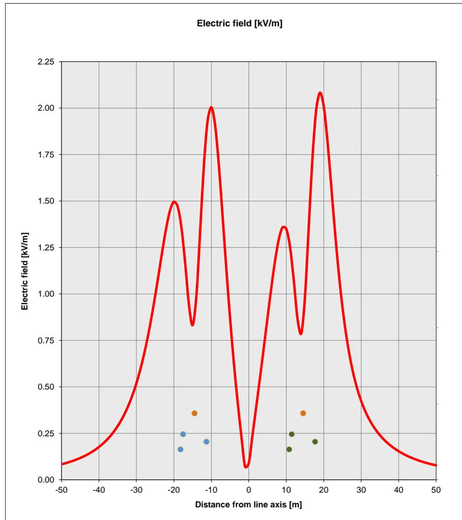
**Fig. 2: andamento del campo elettrico in una sezione perpendicolare agli assi delle linee, calcolato ad 1,5 m dal suolo**
