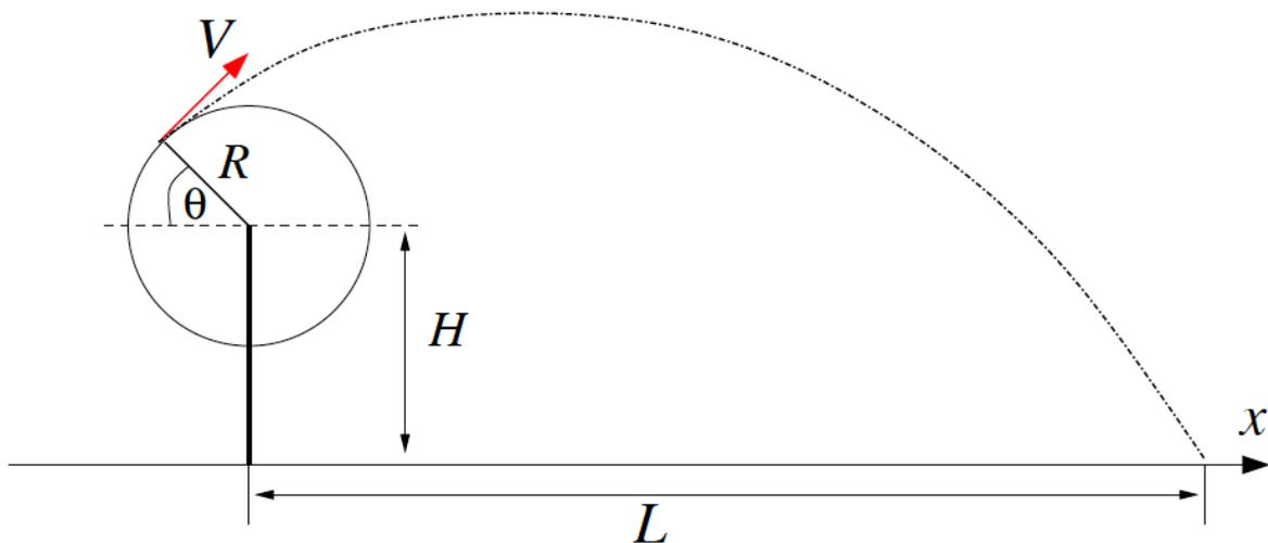
La posizione e la velocità iniziale sono determinati dall'angolo  $\theta$ , dalla velocità tangenziale  $V$  del frammento di pala al momento del distacco. Essi sono legati alla posizione ed alla velocità iniziale dalle relazioni:
