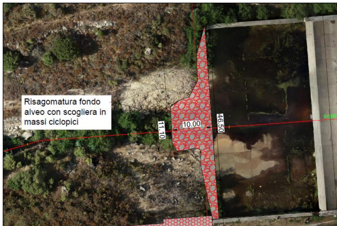
Figura 25 - Intervento con scogliera in massi ciclopici
