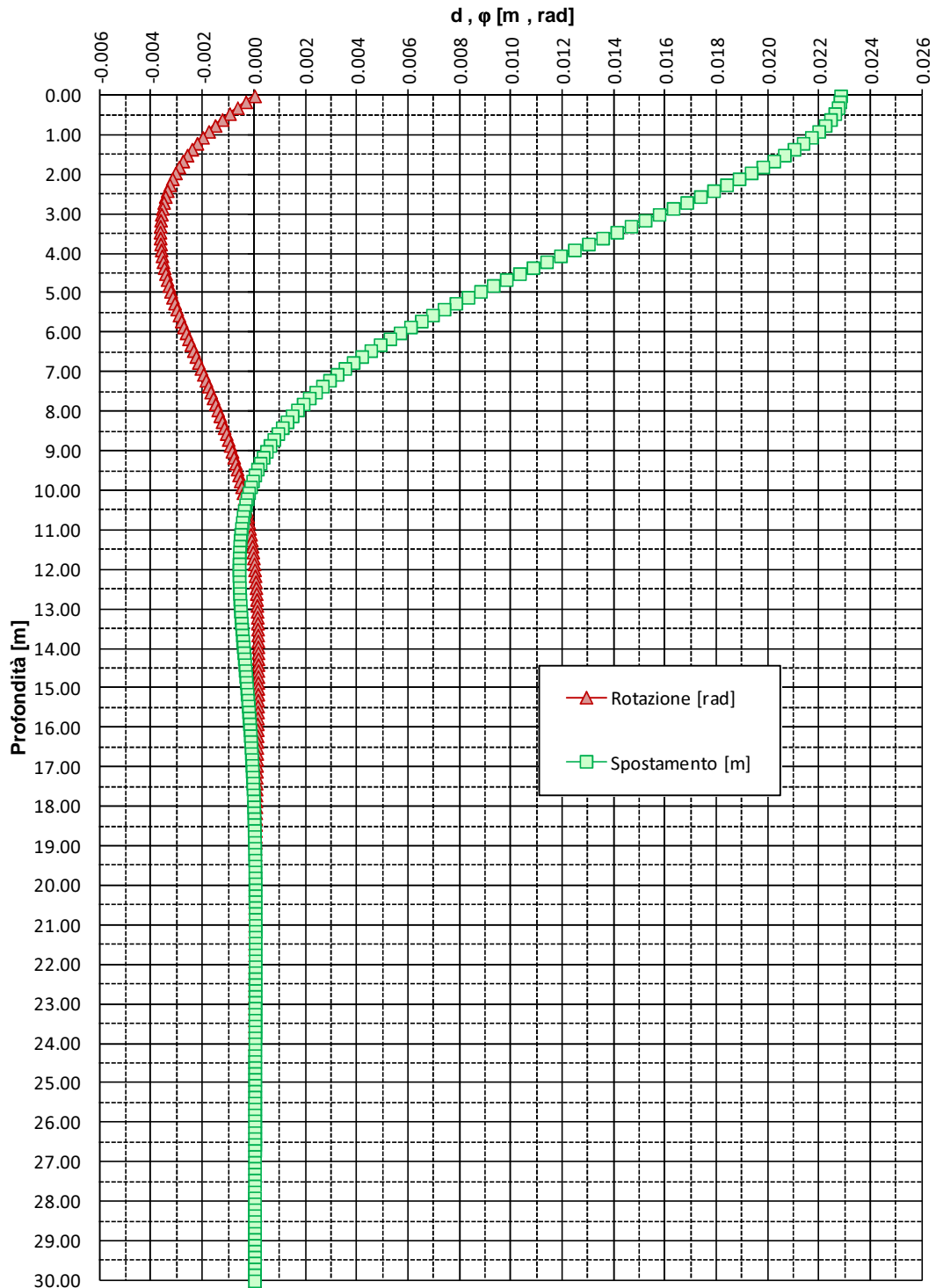
FIGURA 6-2: SPOSTAMENTI E ROTAZIONI – PALI TRIVELLATI \phi 1000
