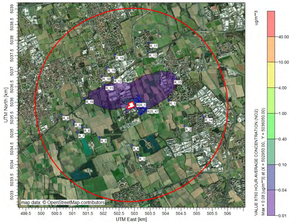
Figura 6-6 | Mappa delle concentrazioni medie annuali di NO2 nello scenario 1b di manutenzione (mitigato con SCR)
