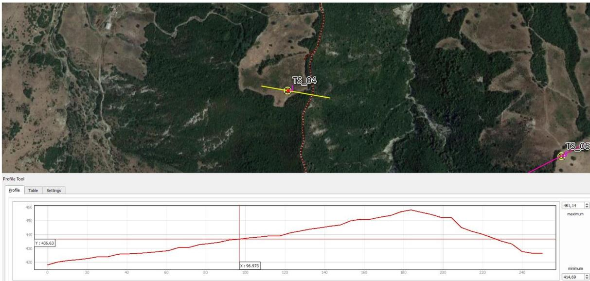
L'area di sedime dell'aerogeneratore TS\_04 è ubicata alla quota di 436,6 metri s.l.m. su un versante esposto ad Ovest, avente una discreta pendenza in corrispondenza del punto di installazione.
