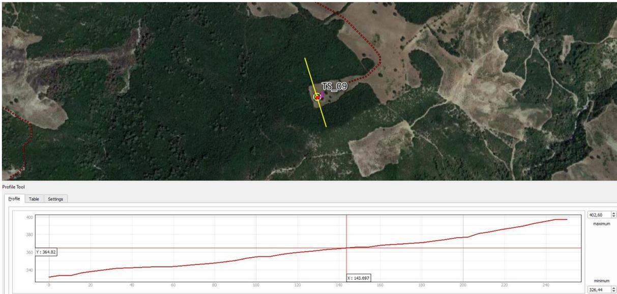
L'area di sedime dell'aerogeneratore TS\_09 è ubicata alla quota di 364,8 metri s.l.m. su un versante esposto ad Nord-Ovest, avente una discreta pendenza in corrispondenza del punto di installazione.
