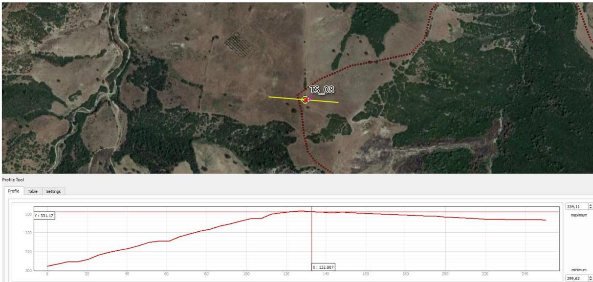
L'area di sedime dell'aerogeneratore TS\_08 è ubicata alla quota di 331,2 metri s.l.m. in corrispondenza di versante esposto a Est, avente una discreta pendenza in corrispondenza del punto di installazione.
