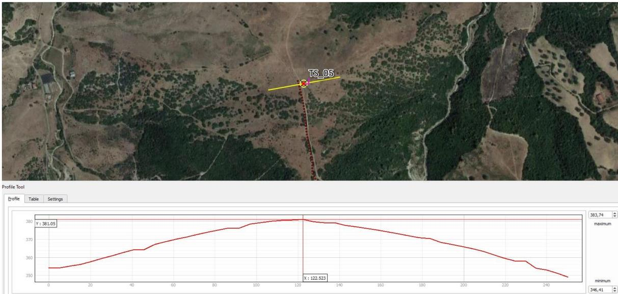
L'area di sedime dell'aerogeneratore TS\_05 è ubicata alla quota di 381,0 metri s.l.m. in corrispondenza di una piccola dorsale avente direzione Nord-Sud che divide i bacini del Vallone Tumavoio e del Fosso del Vallo, avente una discreta pendenza in corrispondenza del punto di installazione.
