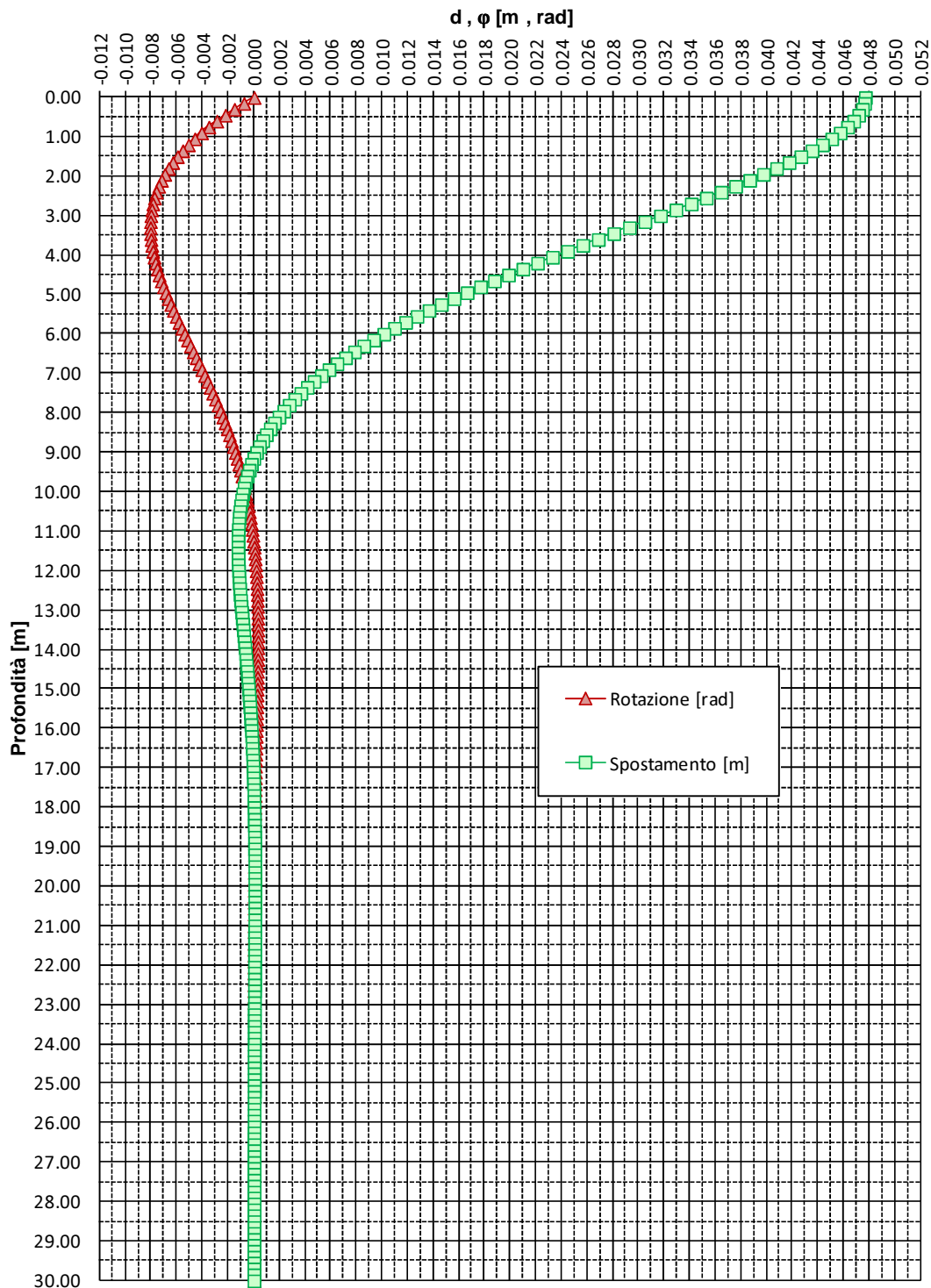
FIGURA 6-12: SPOSTAMENTI E ROTAZIONI – PALI TRIVELLATI φ 800 – MS05 E MS06
