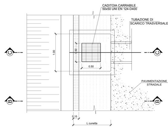
DRENAGGIO ACQUE DI PIATTAFORMA STRADALE IN RILEVATO - PIANTA
