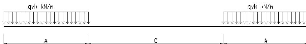
Figura 3 – Modello di carico LM71
