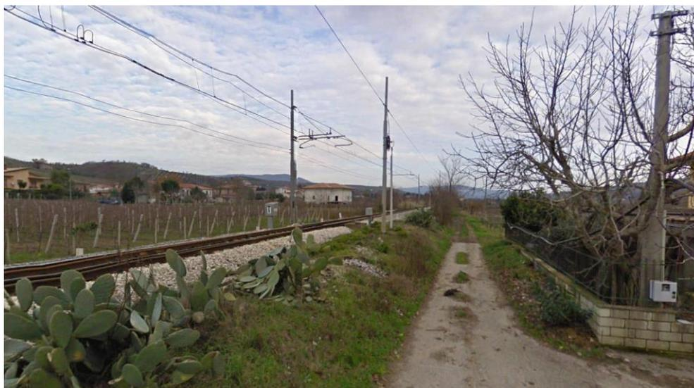
Figura 9: sede stradale attuale - carenza di protezioni marginali, assenza della sovrastruttura stradale, assenza di segnaletica orizzontale e verticale
