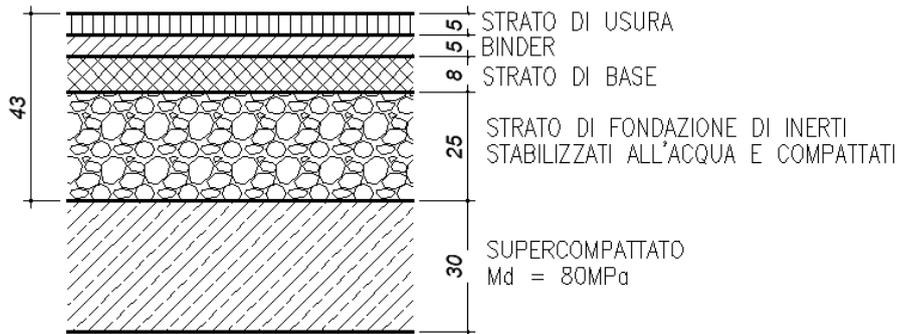
Figura 7: schema sovrastruttura stradale
