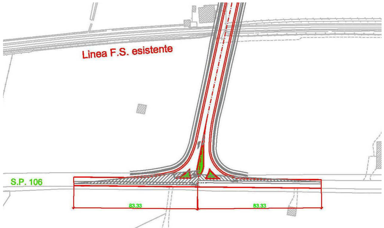
Figura 4: Triangoli di visibilità
