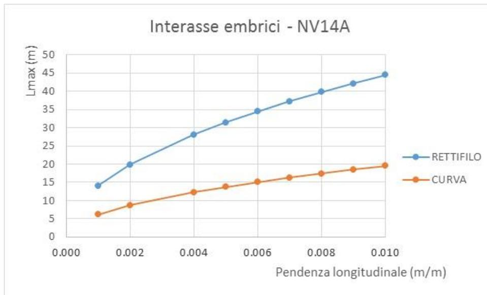
Figura 4: Distanza minima degli scarichi in rilevato
