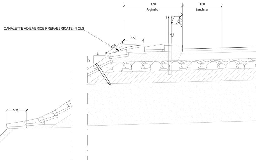
DRENAGGIO ACQUE DI PIATTAFORMA STRADALE IN TRINCEA - SEZIONE B-B
