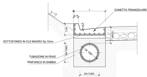
DRENAGGIO ACQUE DI PIATTAFORMA STRADALE IN TRINCEA - SEZIONE C-C
