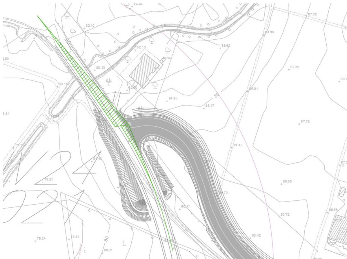
**Figura 6 – Intersezione NV25 – NV24: verifiche di visibilità**
