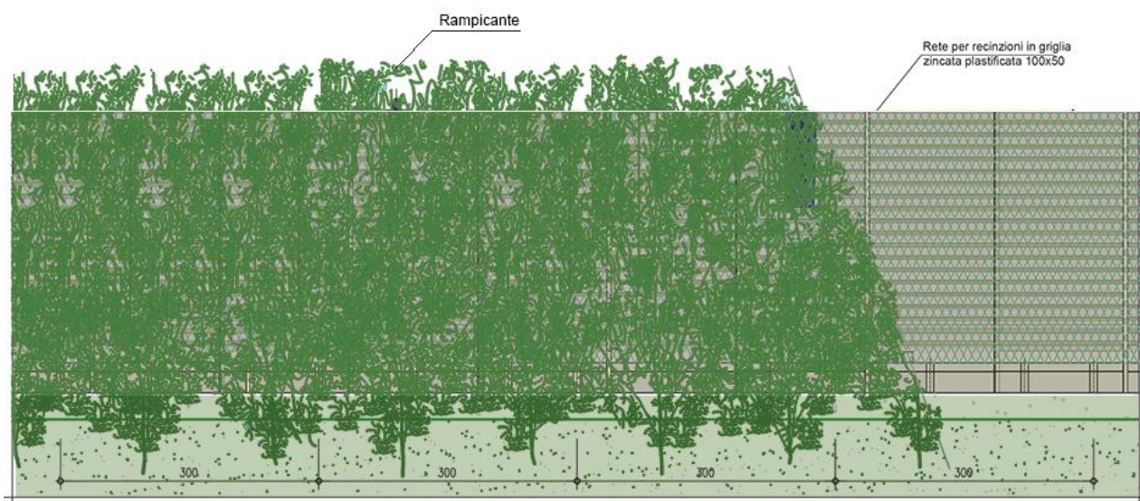
FIGURA 2 – TIPOLOGICO BARRIERA STANDARD– SEZIONE CON RAMPICANTE
