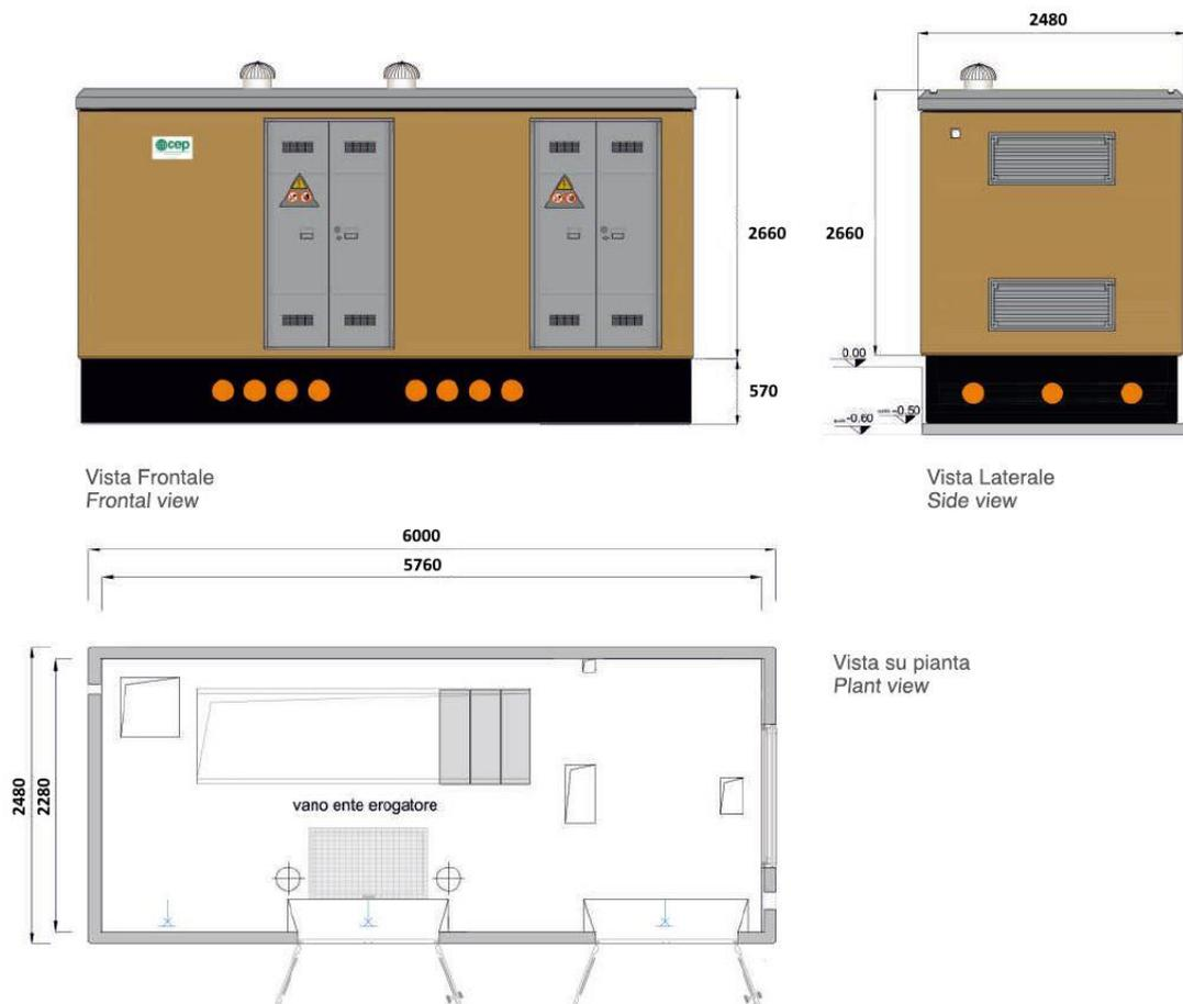
Figura 36 - Cabina elettrica di trasformazione monoblocco
