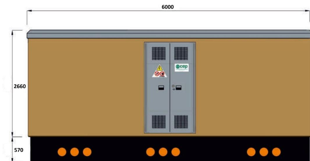
Figura 37 - Cabina elettrica di conversione monoblocco
