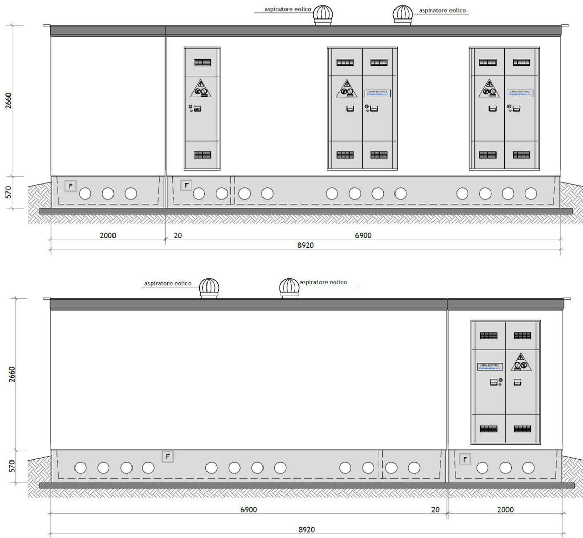
Figura 35 - Cabina elettrica monoblocco prefabbricata - Cabina di consegna e cabina elettrica generale di impianto
