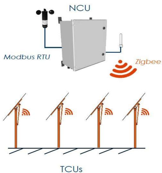
*Figura 32* – Modalità di comunicazione sistema ad inseguimento solare
