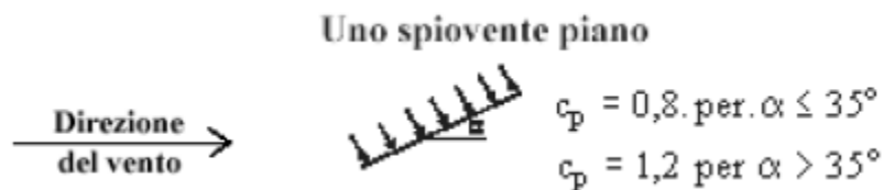
Fig. 4 - Definizione dei coefficienti di pressione
