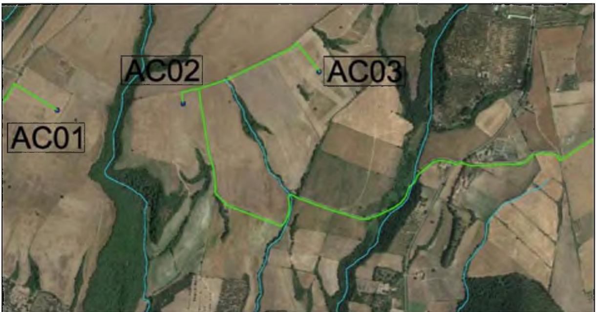
Figura 51 Intersezione del cavidotto con il reticolo idrografico su ortofoto (WTG AC02 – AC03)
