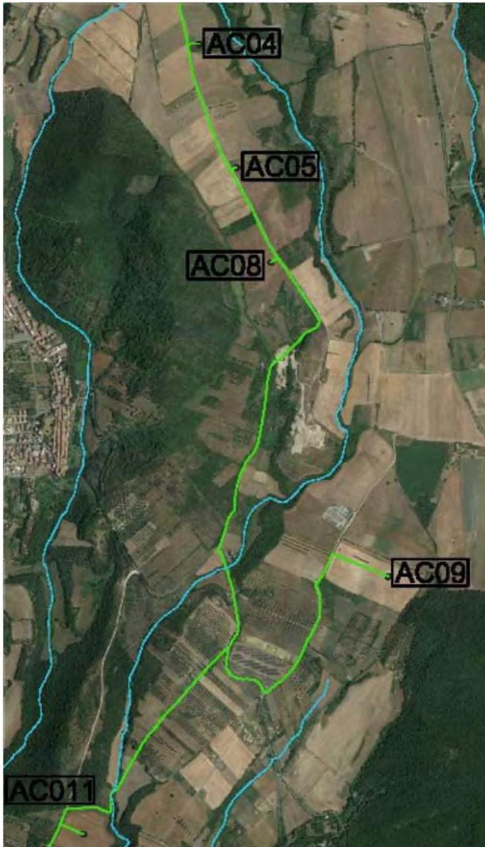
Figura 53 Intersezione del cavidotto con il reticolo idrografico so ortofoto (WTG AC04 – AC05 – AC08 – AC09 – AC11)
