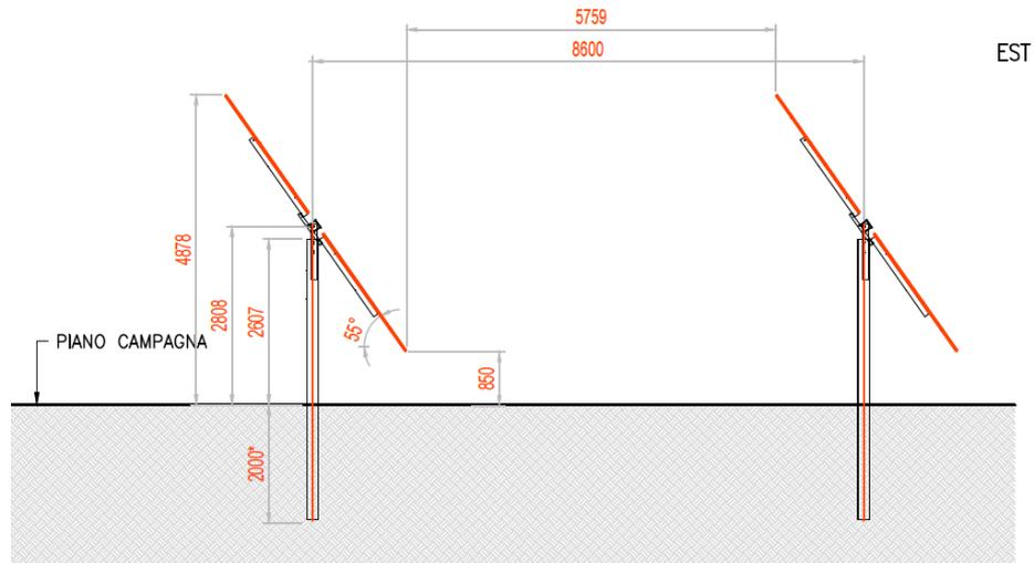
Figura 3.2: Particolare strutture di sostegno moduli
