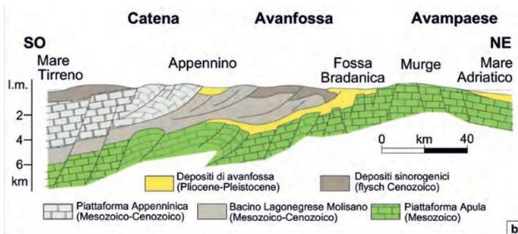
Figura 2.5: Sezione geologica schematica attraverso l'avanfossa appenninica.
