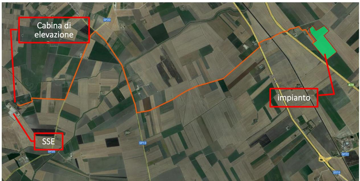
Figura 3.7: In ARANCIO il percorso di connessione dal campo FV alla cabina di trasformazione
