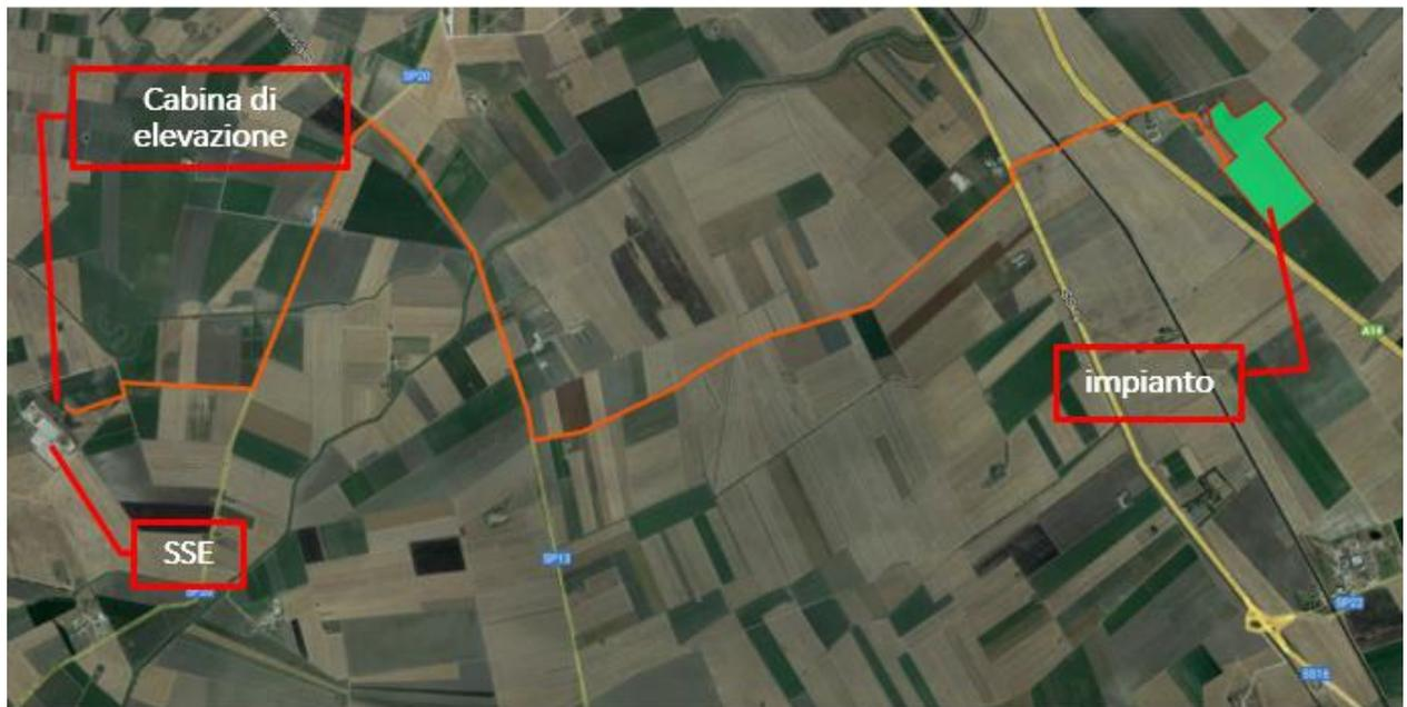
Figura 4.9: In ARANCIO il percorso di connessione dal campo FV alla cabina di trasformazione
