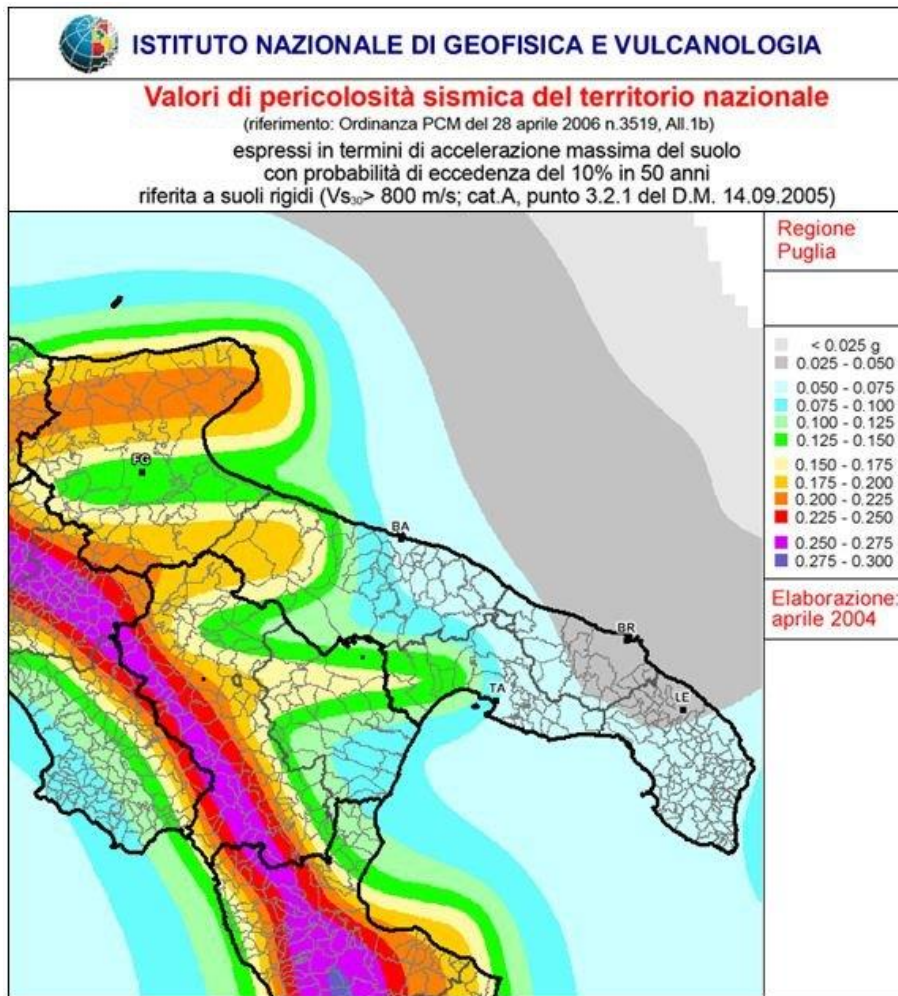
Figura 5.2 – Carta della pericolosità sismica della Puglia.
