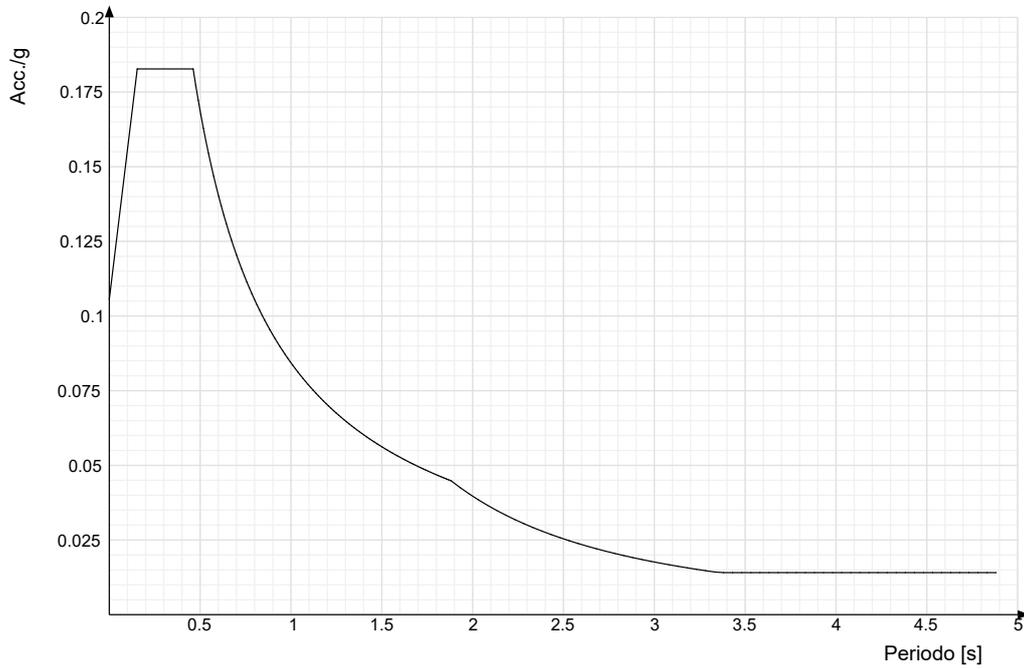
**Spettro di risposta di progetto in accelerazione della componente Y SLD § 3.2.3.5**
