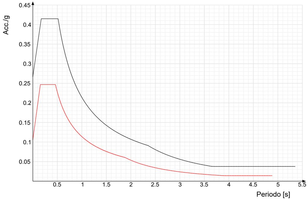
Vengono confrontati lo spettro Spettro di risposta di progetto in accelerazione della componente Y SLD § 3.2.3.5 (di colore rosso) e Spettro di risposta di progetto in accelerazione della componente Y SLV § 3.2.3.5 (di colore nero).
