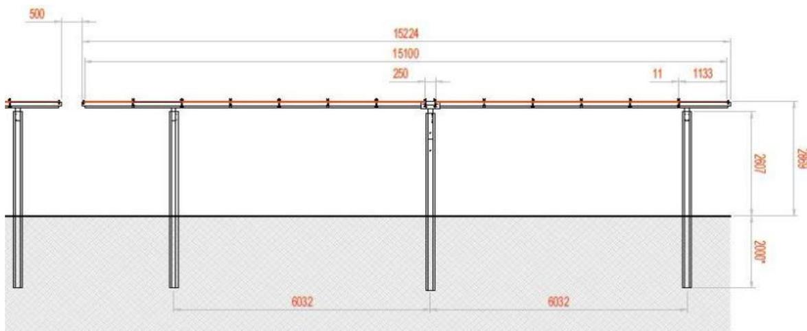
Figura 4.1 – Geometria portale di sostegno pannelli fotovoltaici
