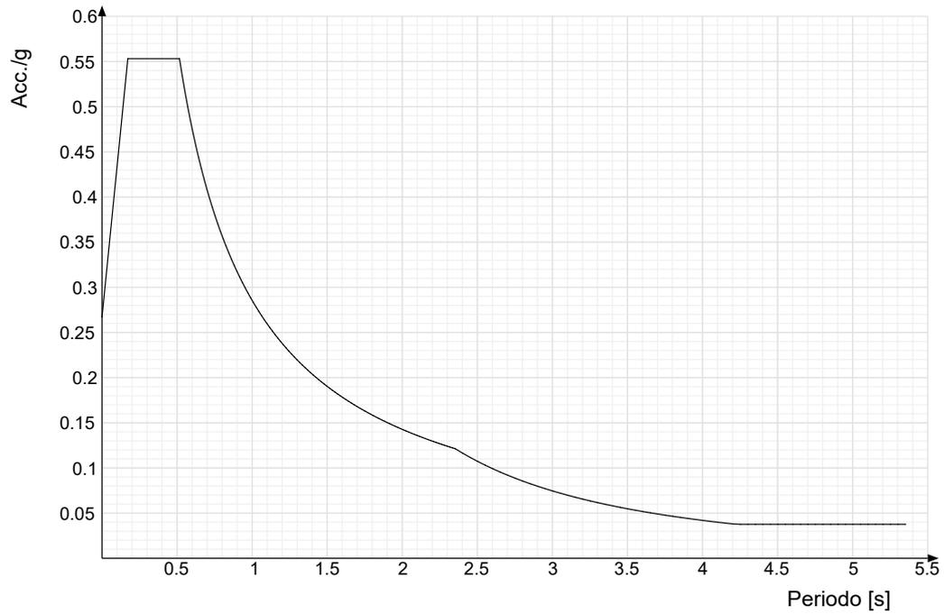
**Spettro di risposta di progetto in accelerazione della componente verticale SLV § 3.2.3.5**
