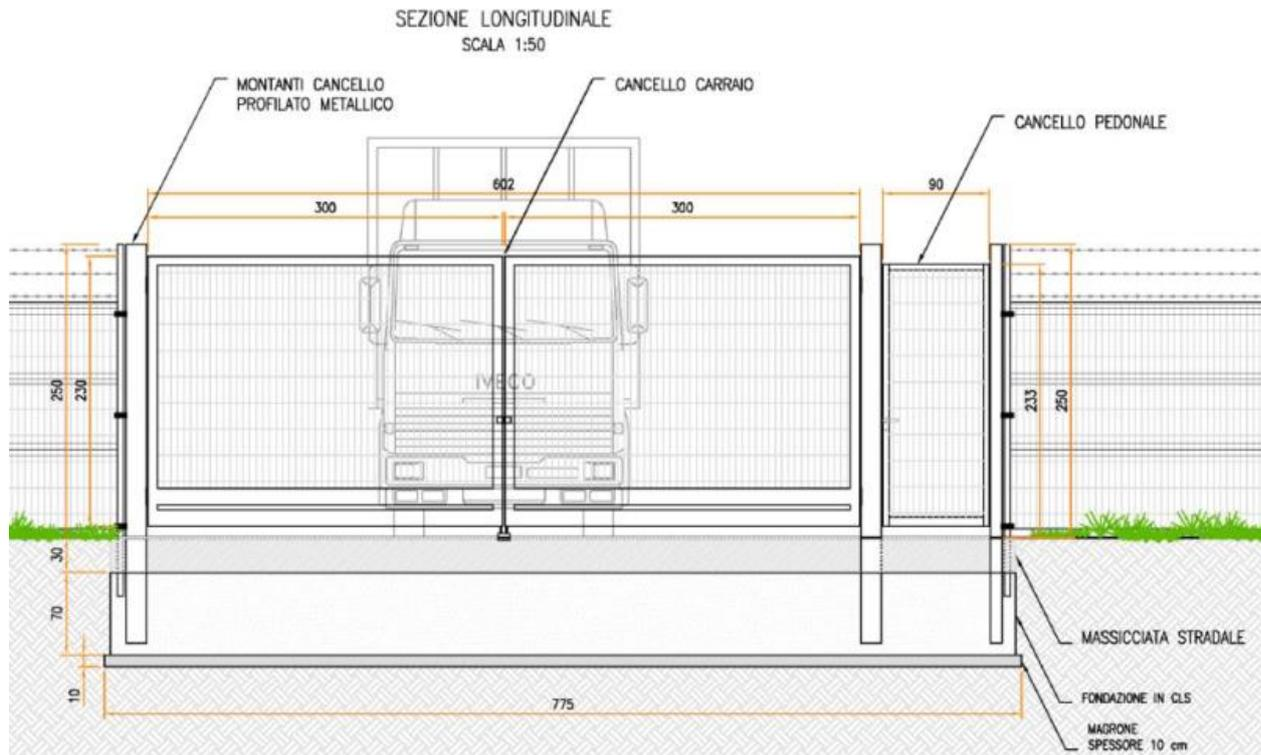
Figura 9.2 – Sezione longitudinale accesso carraio e pedonale
