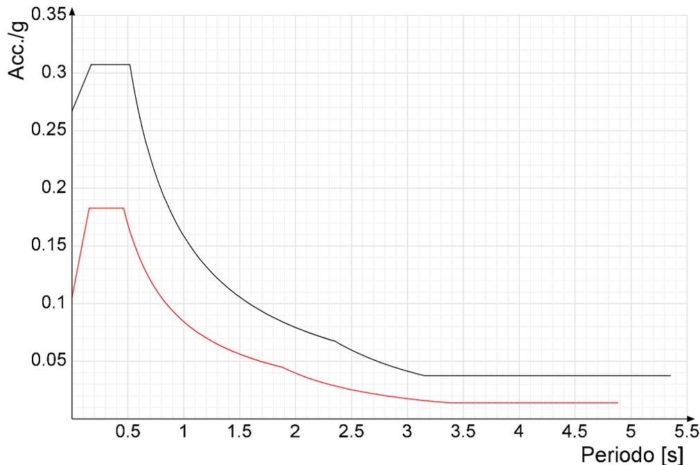
Vengono confrontati lo spettro Spettro di risposta di progetto in accelerazione della componente Y SLD § 3.2.3.5 (di colore rosso) e Spettro di risposta di progetto in accelerazione della componente Y SLV § 3.2.3.5 (di colore nero).
