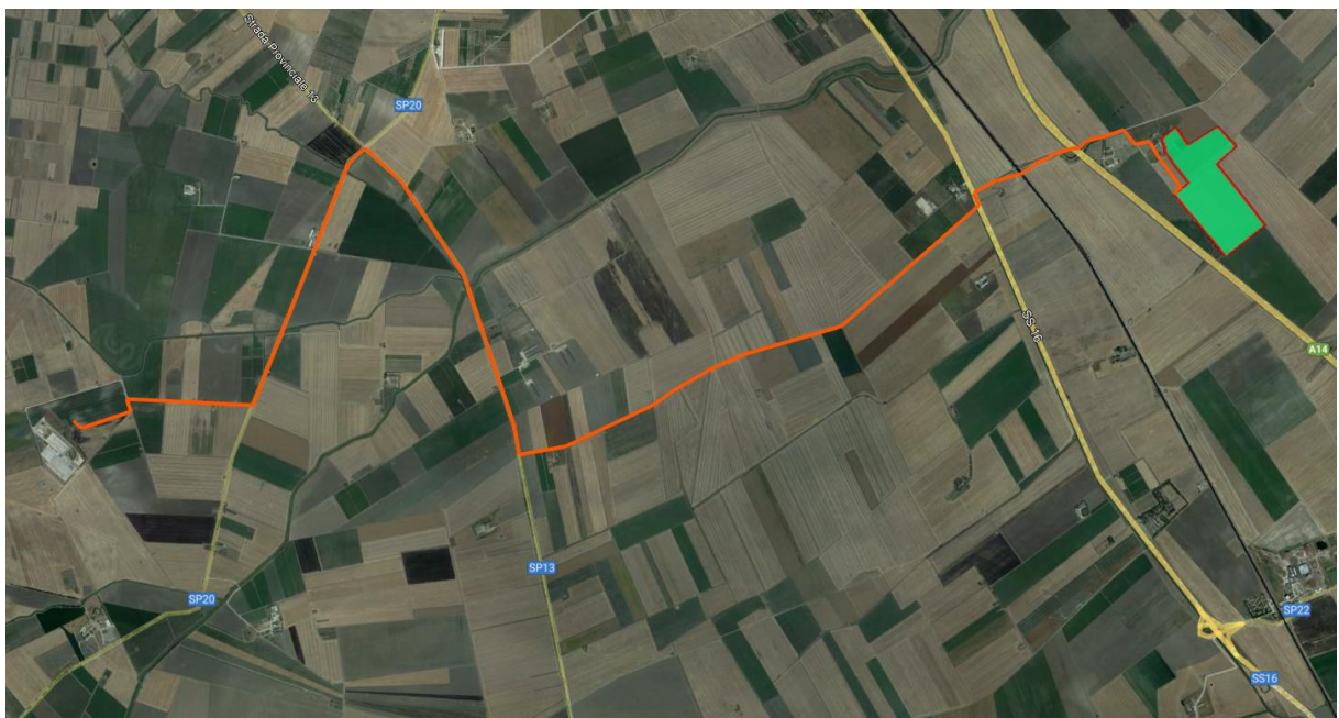
Figura 2.12: In ROSSO il percorso di connessione dal campo FV alla cabina di trasformazione
