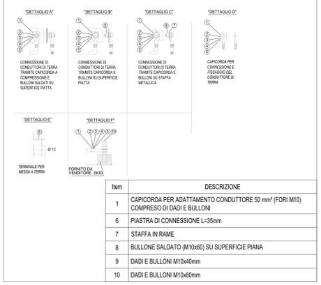
CONDUTTORI METALLICI SALDATI
