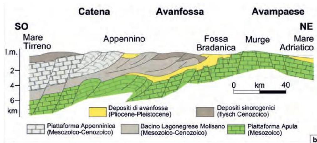
Figura 3.2: Sezione geologica schematica attraverso l'avanfossa appenninica.
