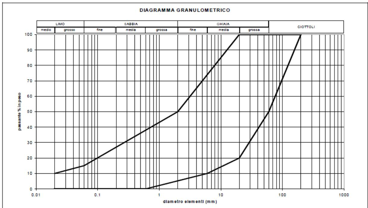
Figura 6.1: fuso granulometrico per materiale da rilevato
