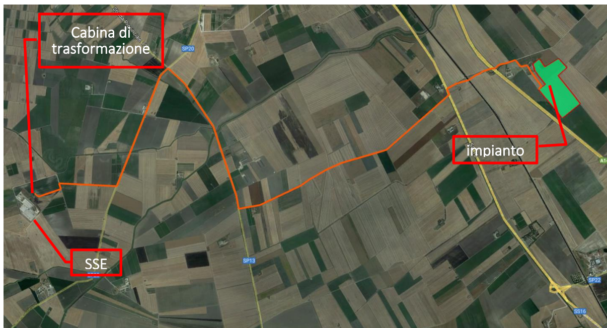
Figura 2.47: In ARANCIO il percorso di connessione dal campo FV alla cabina di trasformazione
