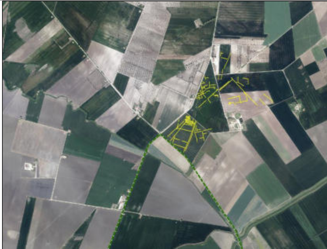
Stralcio dell'ortofoto 2019 SIT Regione Puglia con le anomalie (in giallo) relative a viabilità e ripartizioni agrarie in località Motta del Lupo ed indicazione delle opere in progetto (cavidotto in verde).
