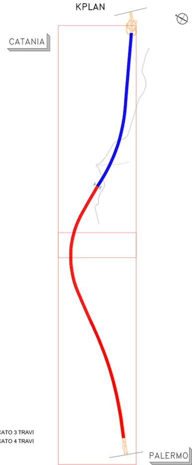
E' PREVISTA LA COMPLETA DEMOLIZIONE DEGLI IMPALCATI DEL TIPO "A 3 TRAVI" SULLA CARREGGIATA PA-CT (n° 55 CAMPATE) - ALCUNE CAMPATE SONO STATE OGGETTO DI INTERVENTI DI CONSOLIDAMENTO DELLE SOLETTE E DELLE TRAVI ESEGUITI NELL'AMBITO DEI PRECEDENTI LAVORI DI RIPRISTINO STATICO E RIQUALIFICAZIONE DEL VIADOTTO MORELLO.
