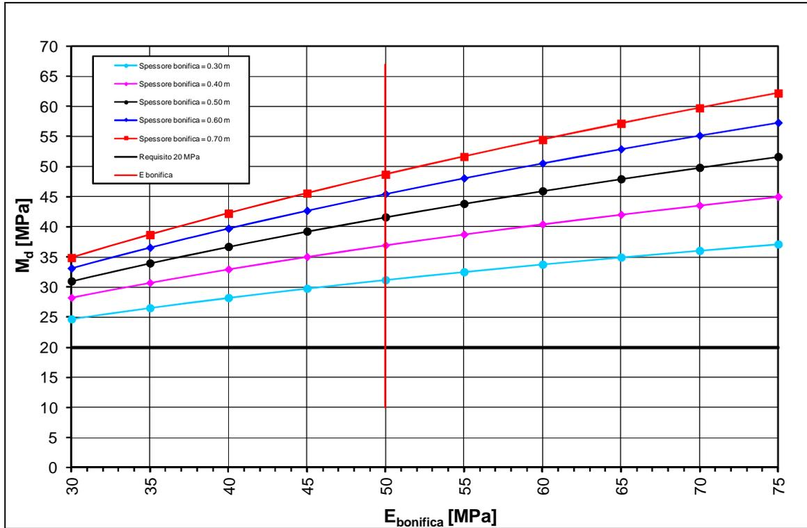
FIGURA 4-3: HRIL > 1M – DETERMINAZIONE SPESSORE DI BONIFICA.
