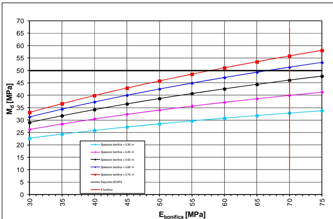
**FIGURA 4-2: HRIL ≤ 1M – DETERMINAZIONE SPESSORE DI BONIFICA.**
