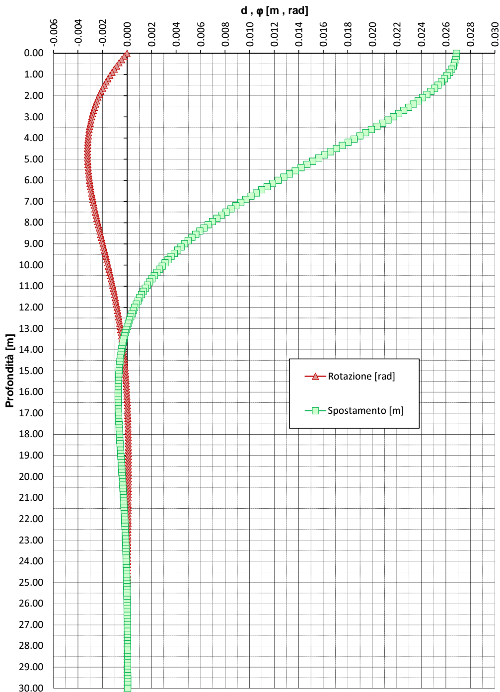
FIGURA 6-4: SPOSTAMENTI E ROTAZIONI – PALI TRIVELLATI φ 1200
