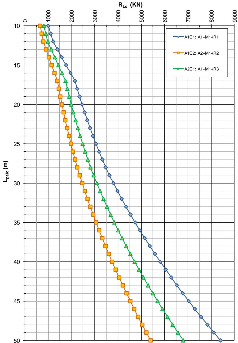
**FIGURA 4-2: CAPACITÀ PORTANTE A TRAZIONE – PALI TRIVELLATI  $\phi$  1200**
