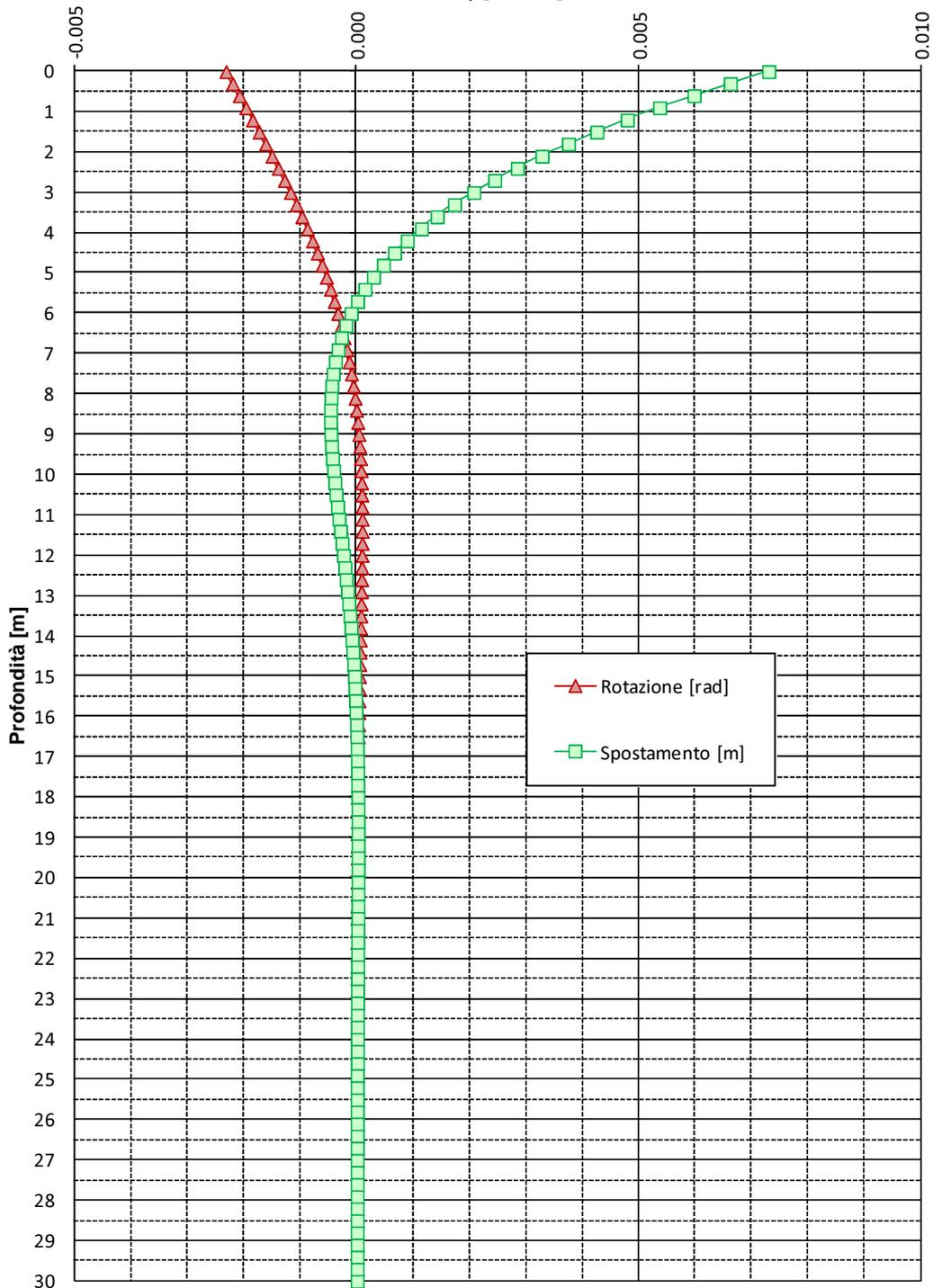
**FIGURA 6-4: SPOSTAMENTI E ROTAZIONI – PALI TRIVELLATI φ 1200 (MOMENTO IN TESTA)**
