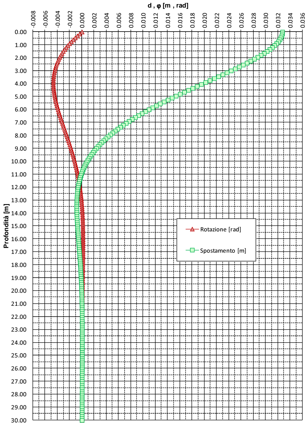
FIGURA 6-2: SPOSTAMENTI E ROTAZIONI – PALI TRIVELLATI φ 1000
