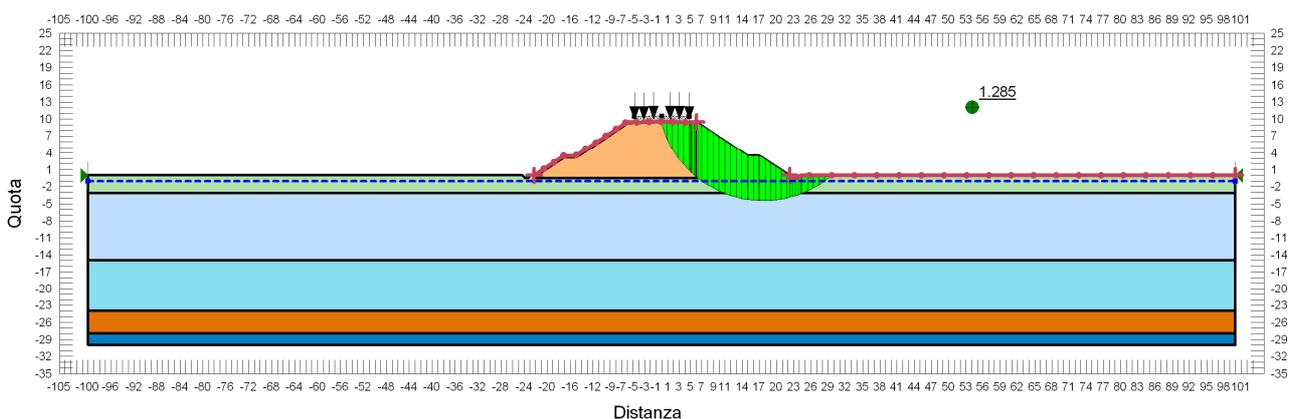
**FIGURA 11-6: VERIFICA DI STABILITÀ GLOBALE RILEVATO DI H=9.50 M - CONDIZIONE STATICA DRENATA.**
