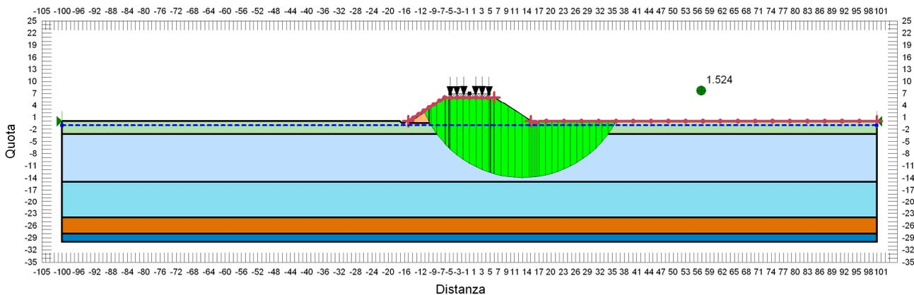
**FIGURA 11-3: VERIFICA DI STABILITÀ GLOBALE RILEVATO DI H=6.00 M - CONDIZIONE SISMA+.**
