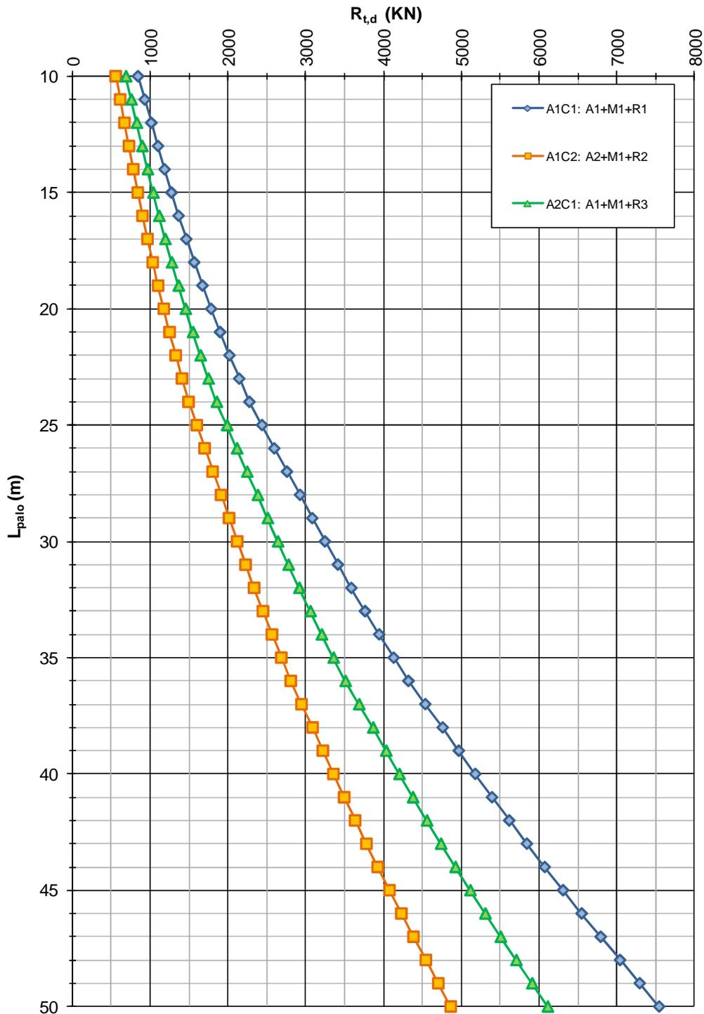
**FIGURA 4-4: CAPACITÀ PORTANTE A TRAZIONE – PALI TRIVELLATI  $\phi$  1200**
