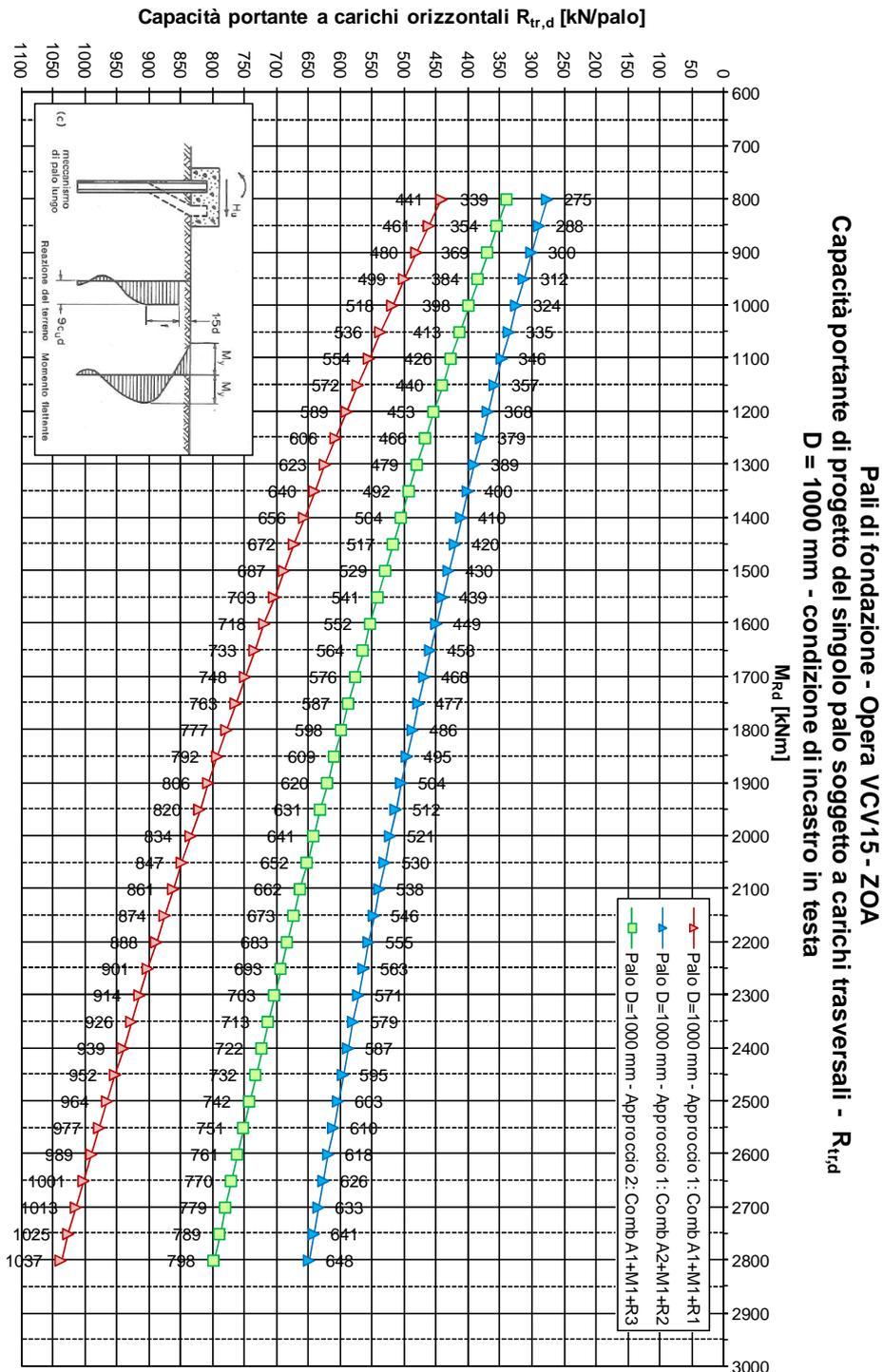
**FIGURA 5-1: CAPACITÀ PORTANTE ORIZZONTALE – PALI TRIVELLATI  $\phi$  1000**
