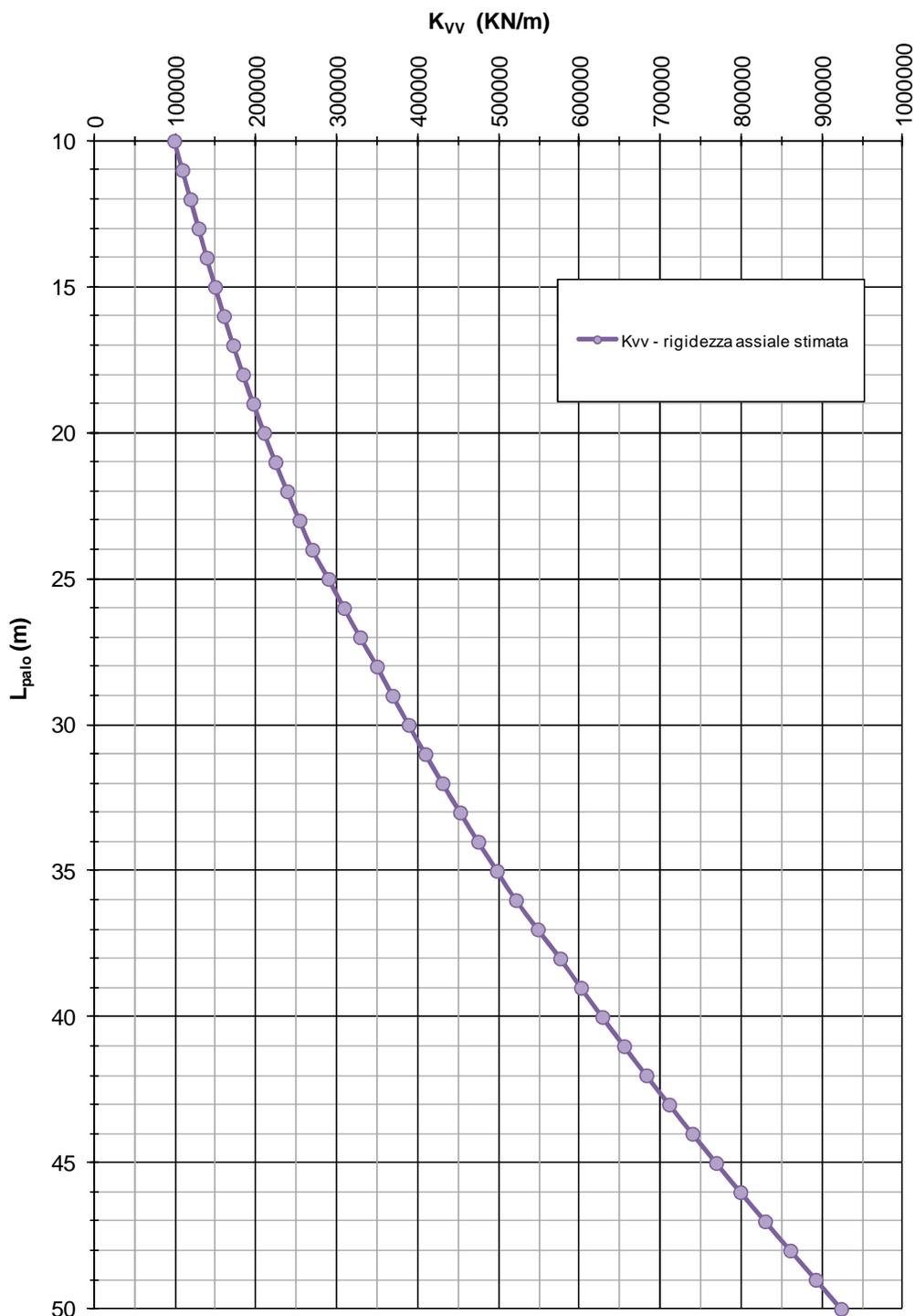
**FIGURA 10-2: RIGIDEZZA VERTICALE – PALI TRIVELLATI  $\phi$  1000**
