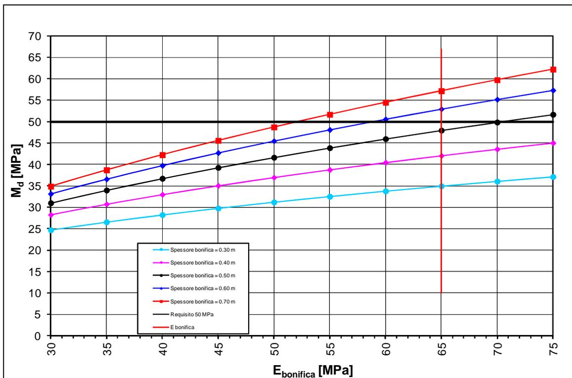
**FIGURA 14-2: HRIL ≤ 1M – DETERMINAZIONE SPESSORE DI BONIFICA.**
