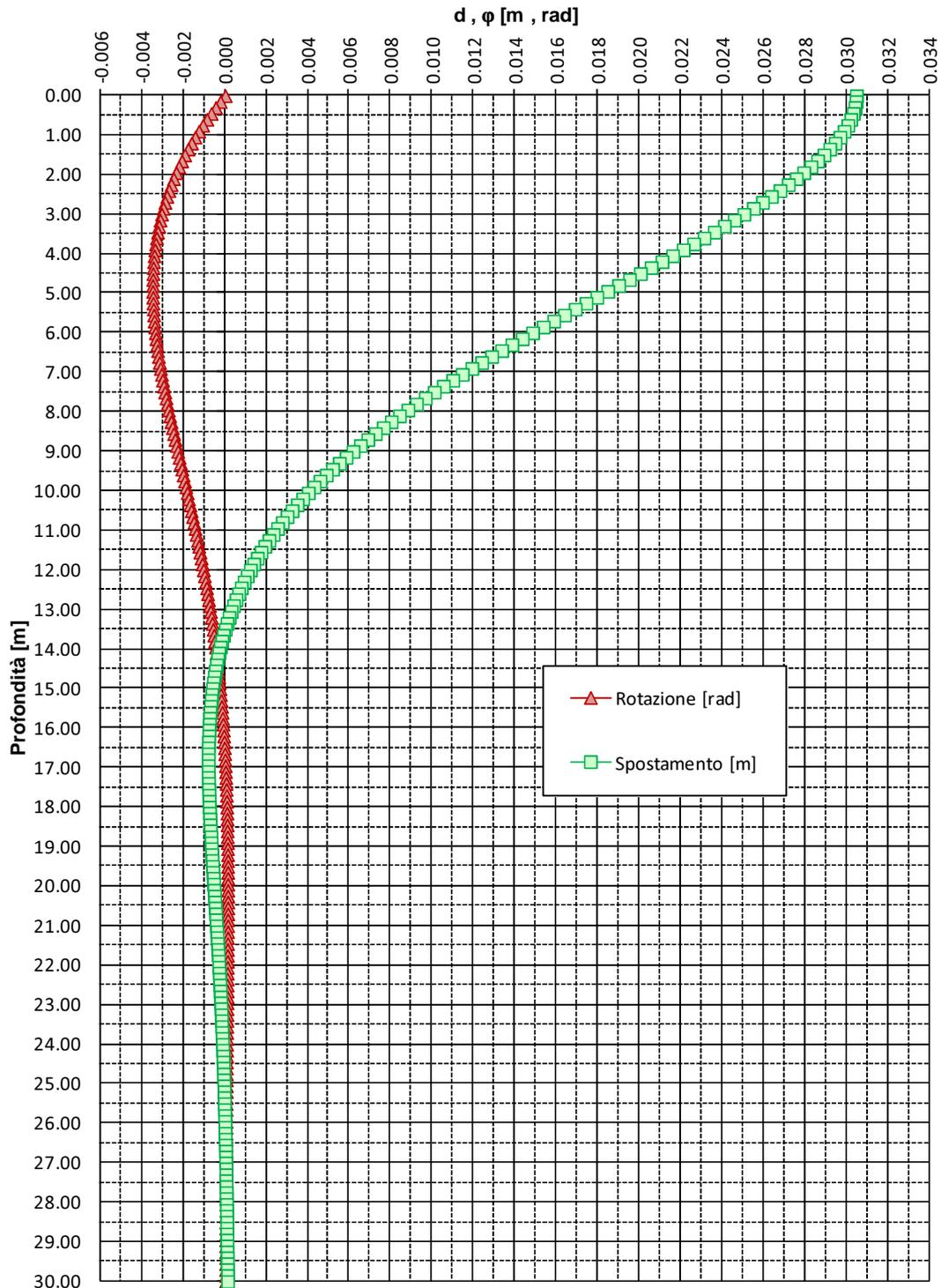
FIGURA 6-4: SPOSTAMENTI E ROTAZIONI – PALI TRIVELLATI  $\phi$  1200
