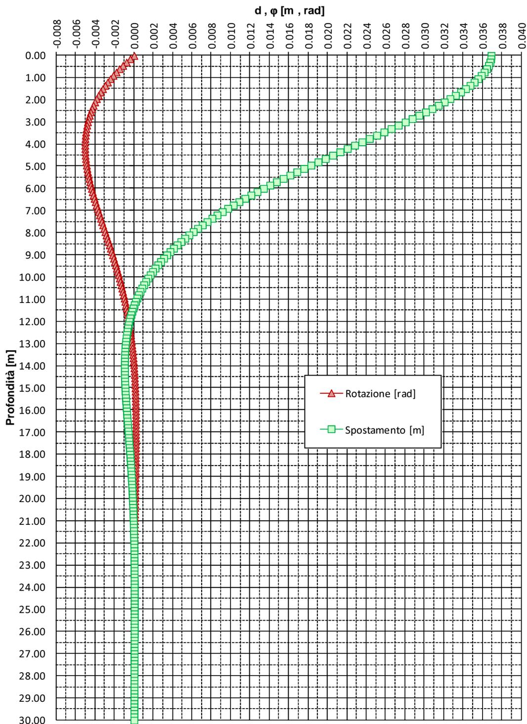
FIGURA 6-2: SPOSTAMENTI E ROTAZIONI – PALI TRIVELLATI  $\phi$  1000
