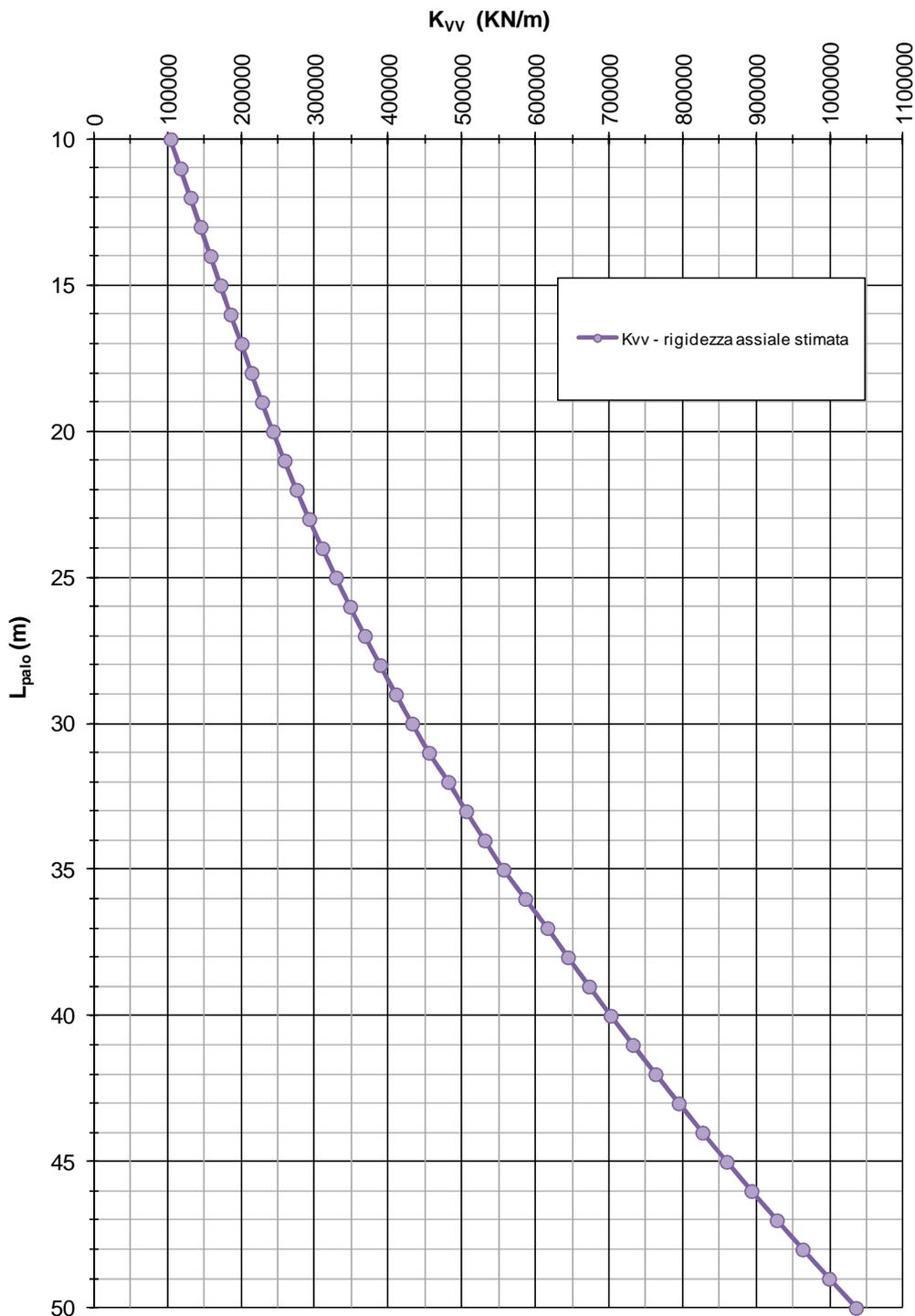
**FIGURA 10-3: RIGIDEZZA VERTICALE – PALI TRIVELLATI  $\phi$  1200**
