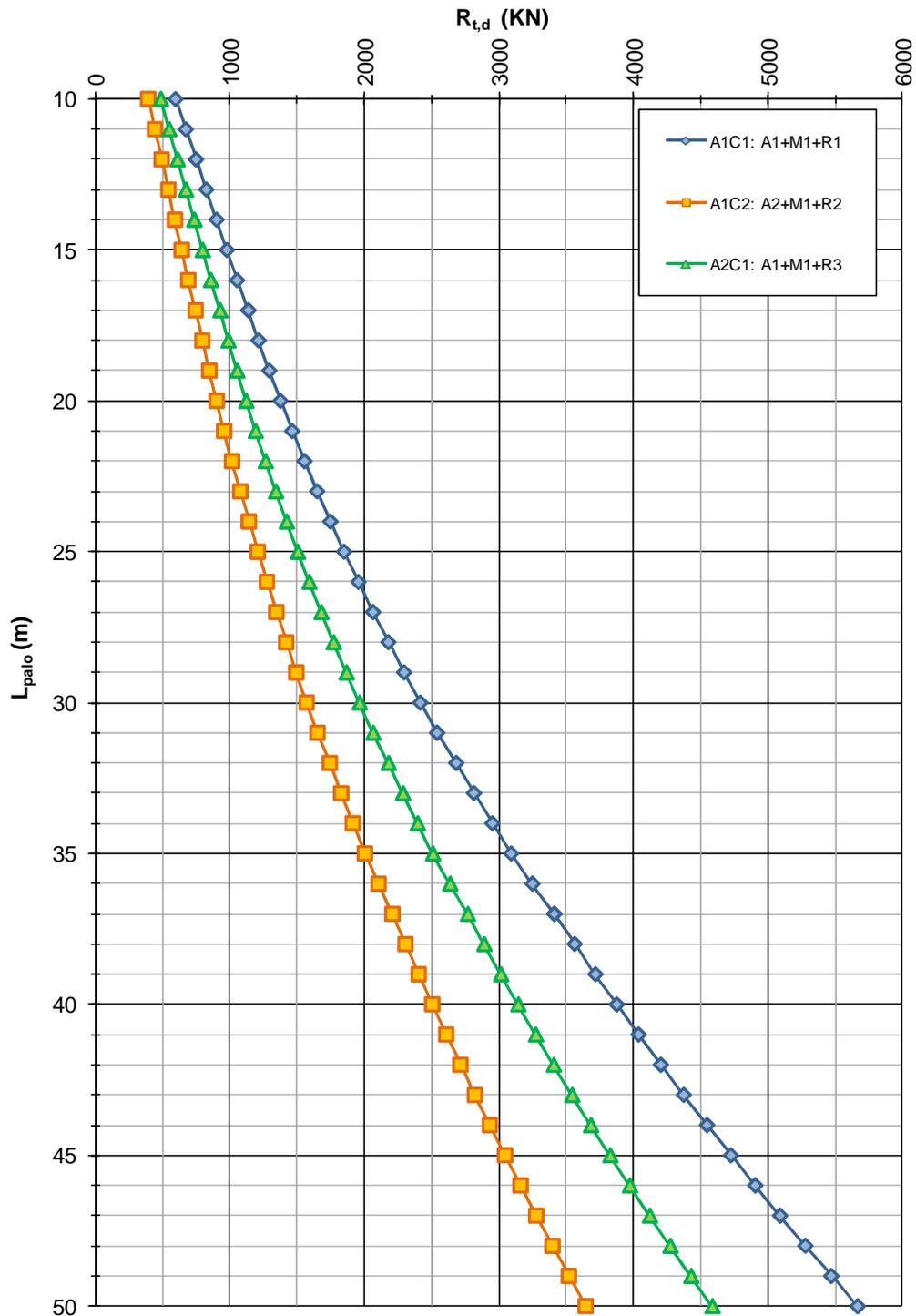
FIGURA 4-2: CAPACITÀ PORTANTE A TRAZIONE – PALI TRIVELLATI  $\phi$  1000
