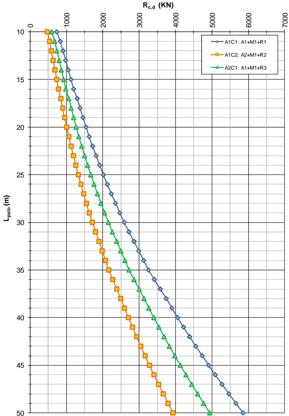
**FIGURA 4-1: CAPACITÀ PORTANTE A COMPRESSIONE – PALI TRIVELLATI  $\phi$  1000**
