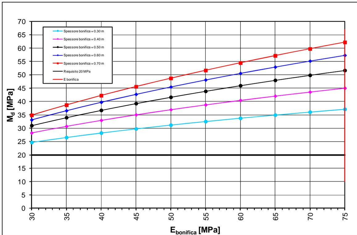
FIGURA 14-3: HRIL > 1M – DETERMINAZIONE SPESSORE DI BONIFICA.
