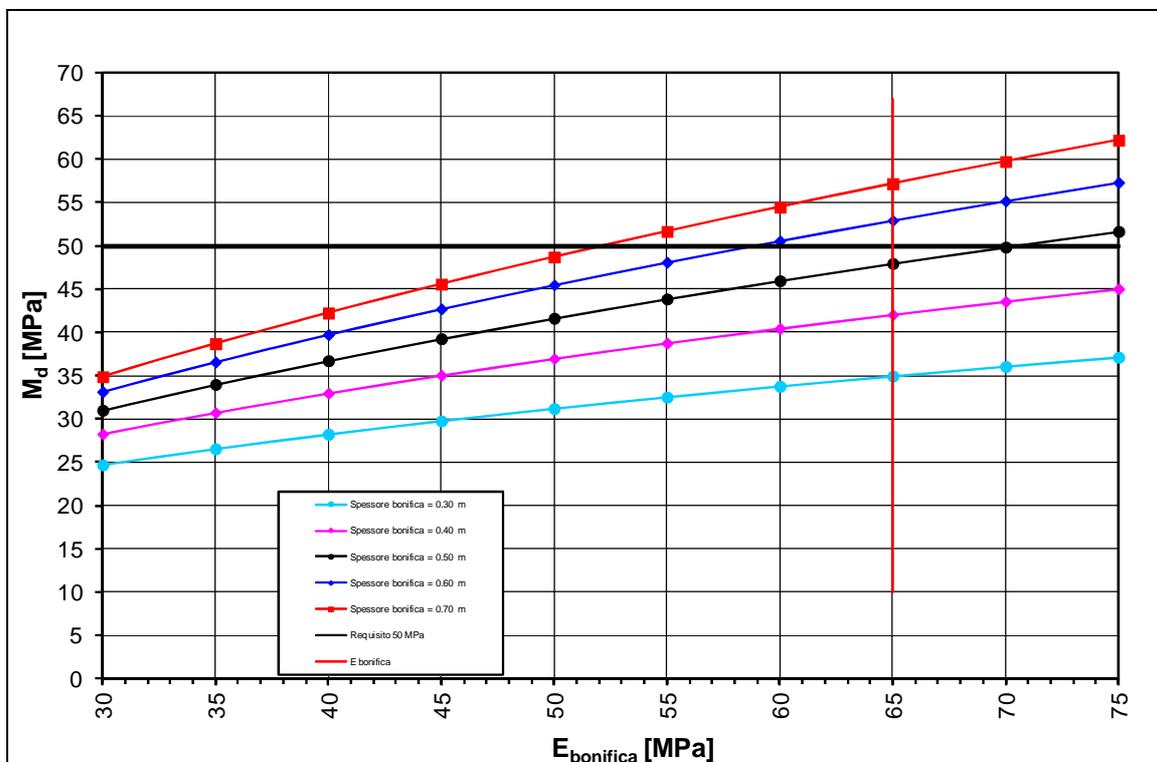
FIGURA 14-2: HRIL  $\leq 1$ M – DETERMINAZIONE SPESSORE DI BONIFICA.
