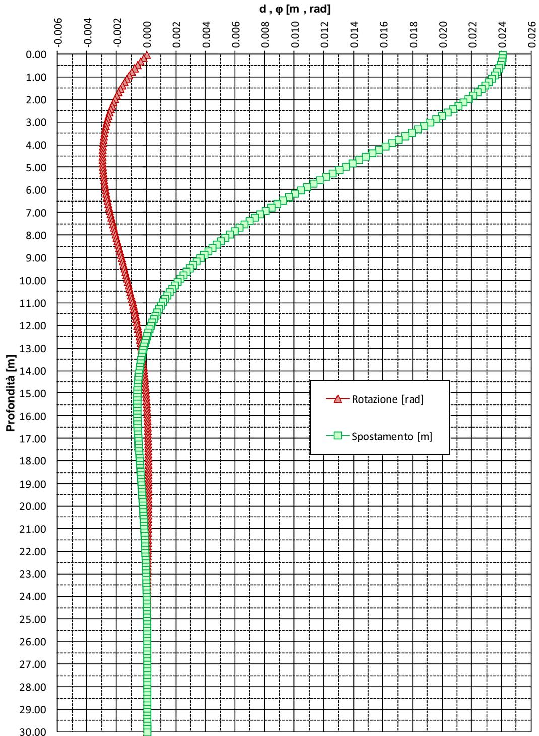
FIGURA 6-4: SPOSTAMENTI E ROTAZIONI – PALI TRIVELLATI φ 1200
