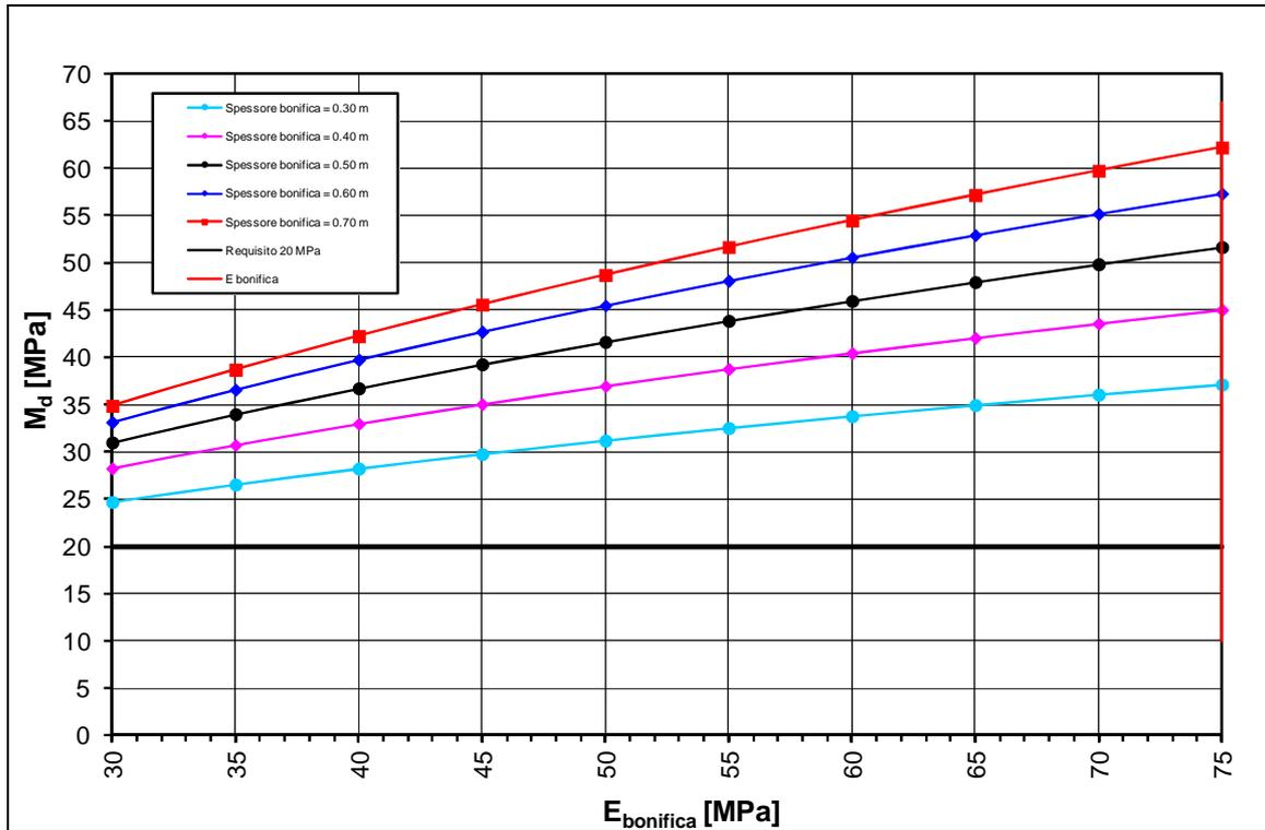
FIGURA 11-3: HRIL > 1M – DETERMINAZIONE SPESSORE DI BONIFICA.
