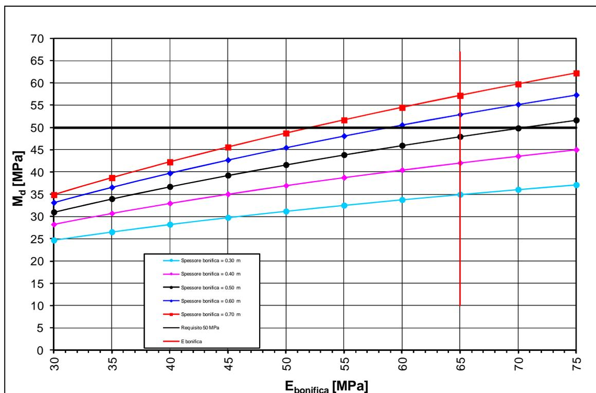
FIGURA 11-2: HRIL  $\leq 1$ M – DETERMINAZIONE SPESSORE DI BONIFICA.
