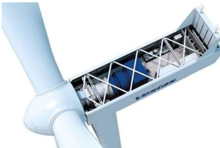
*Figura 1 – Navicella della serie EnVentus, a cui appartiene la V162-5.6 MW*
