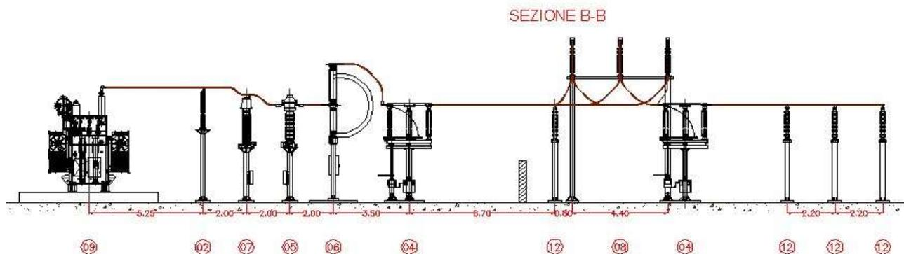
Figura 13 Sezione B-B Sottostazione
