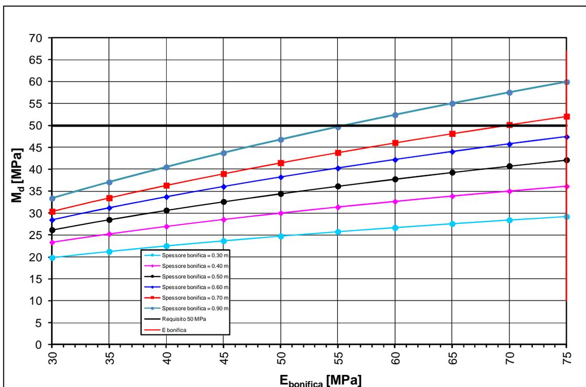
FIGURA 6-2: HRIL ≤ 1m – DETERMINAZIONE SPESSORE DI BONIFICA.
