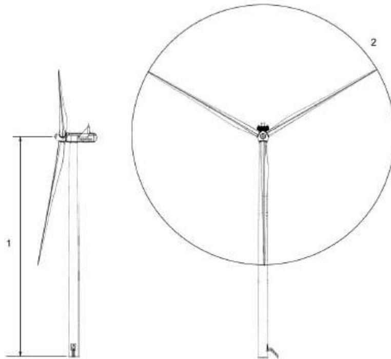
Figura 5 Dimensioni (1 Hhub altezza mozzo - 2 diametro rotore)
